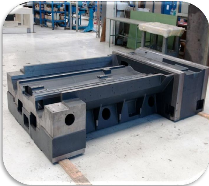
Рисунок 2 Станина горизонтально- фрезерного обрабатывающего центра H50 на заводе- изготовителе ТАИМАС ZPS (Чехия)
