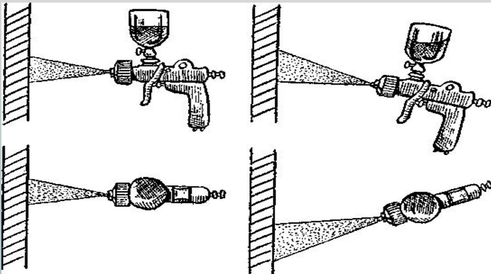
Рис. 45. Положение пульверизатора во время окрашивания а — правильно; б — неправильно
