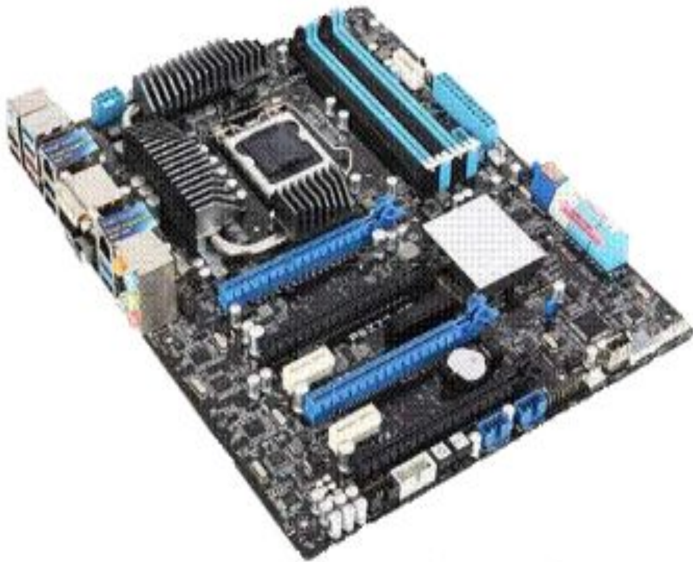
Рис.4.2. Системная плата ASUS P8Z77 WS
