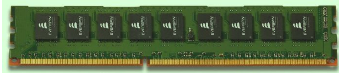
Планка серийного DDR3 формата на STT-MRAM
