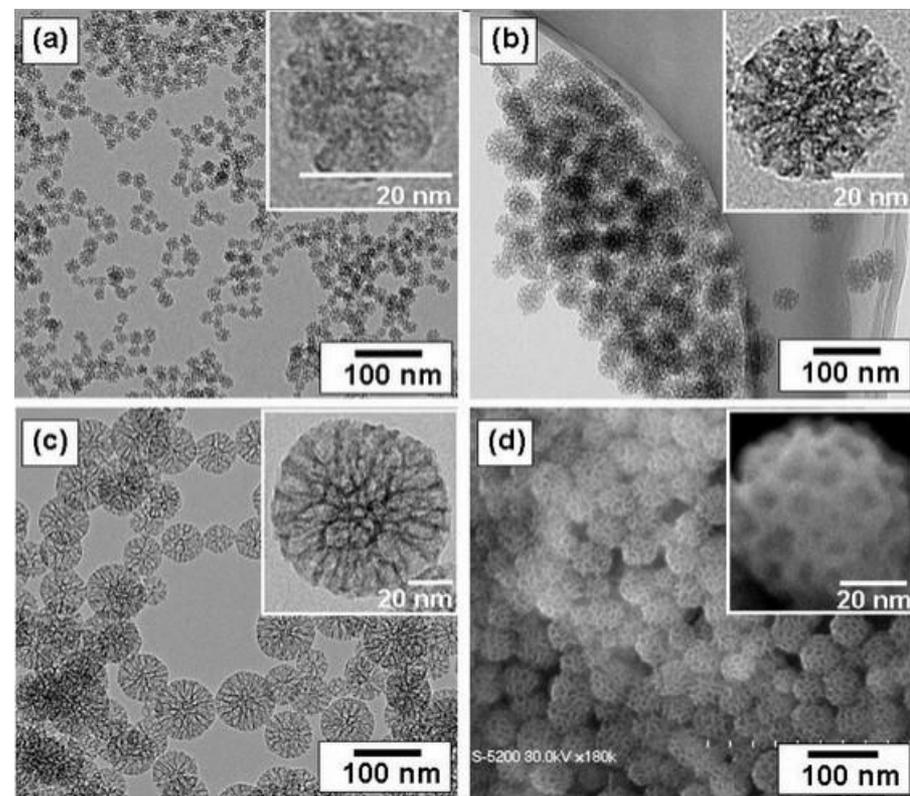
Просвечивающаяся электронная микроскопия (a, b, и c) образы подготовлены как мезопористые наночастицы кремнезема со средним наружным диаметром: (a) 20 нм, (b), изготовленных по технологии 45 нм, и (c) 80 нм. SEM (d) изображения, соответствующие (б). Вставки не являются высоким увеличением мезопористого кремнезема, частицы.
