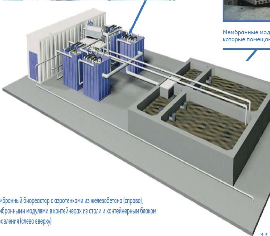
Мембранный биореактор с аэротенками из железобетона (справа), мембранными модулями в контейнерах из стали и контейнерным блоком управления (слева вверху)
