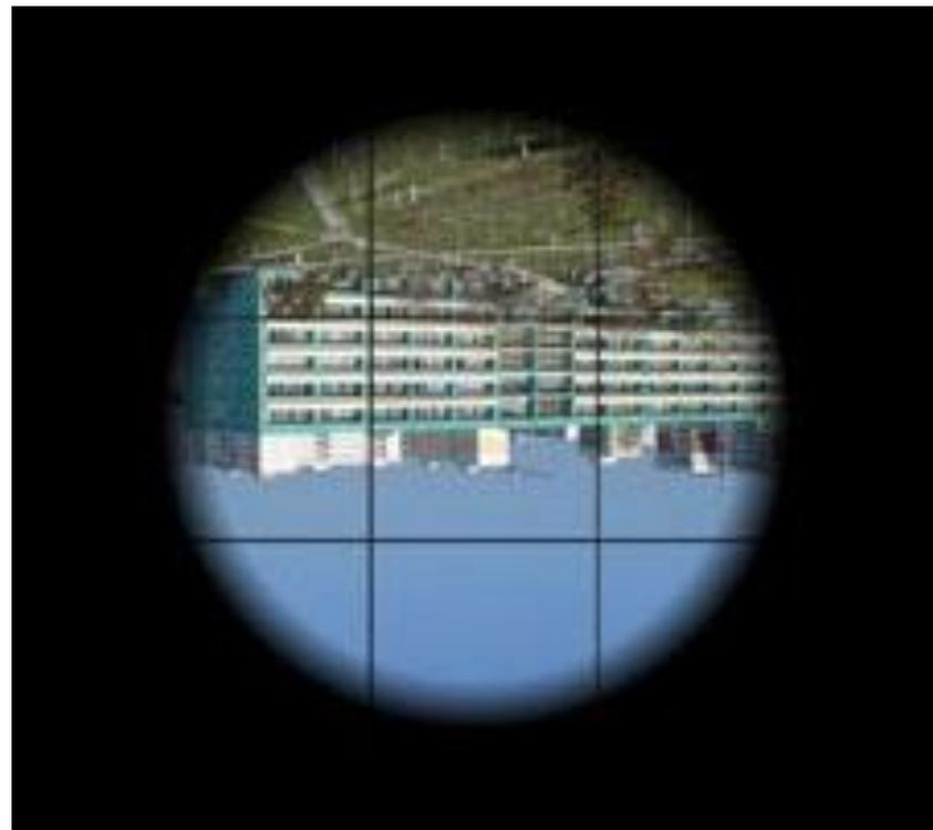
Для этого вращают отверткой верхний и нижний регулировочные винты на кольце стойки трубы, приводя изображение горизонтальной линии в центр квадрата (один винт поджимают, другой отдают).
