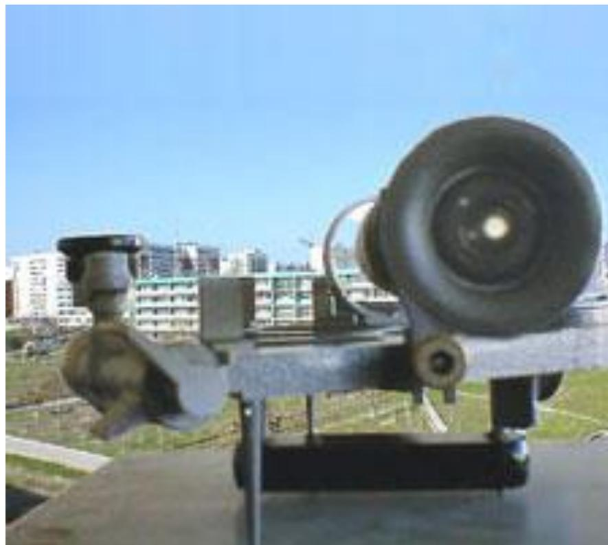
Затем наблюдают предмет в трубу. Если горизонтальная линия не окажется в центре квадрата нитей трубы, то исправляют установку трубы.
