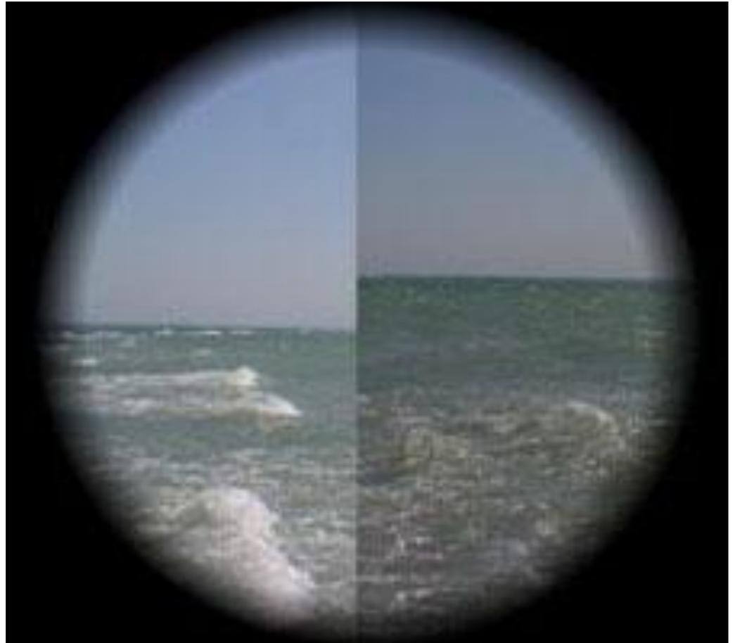
Вращая с помощью торцевого ключа верхний винт малого зеркала, надо переместить дважды отраженное изображение на одну горизонталь с прямовидимым.
