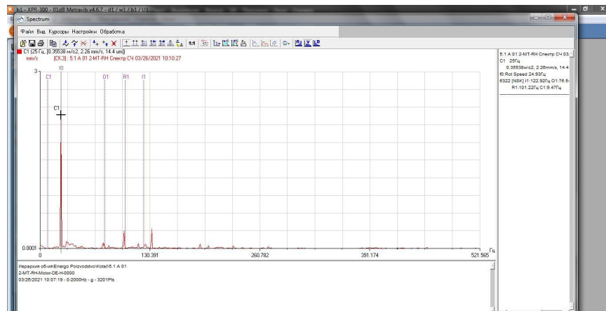
Абсолютная виброскорость подшипников опор электродвигателя
