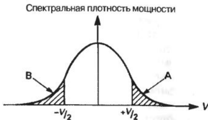
Рис. 5.12. Спектральная плотность мощности шума.
