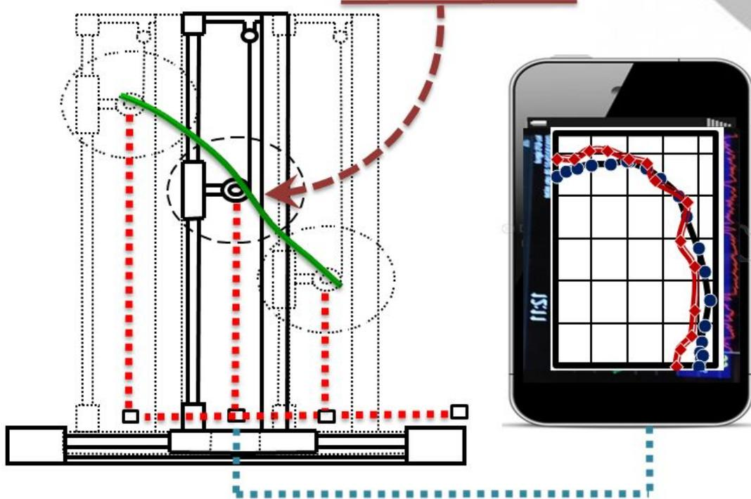
Регистрация биомеханических параметров тренировки ведется системой, включающей датчики, передающие сигнал о текущем положении и времени перемещения грифа штанги на считывающее устройство, а также ПО, обрабатывающее полученный сигнал. При этом один датчик регистрирует движение рамы, а другой датчик – движение грифа штанги. ПО устройства обрабатывает полученные данные одновременно с двух датчиков, объединяя их в единое в целое.
