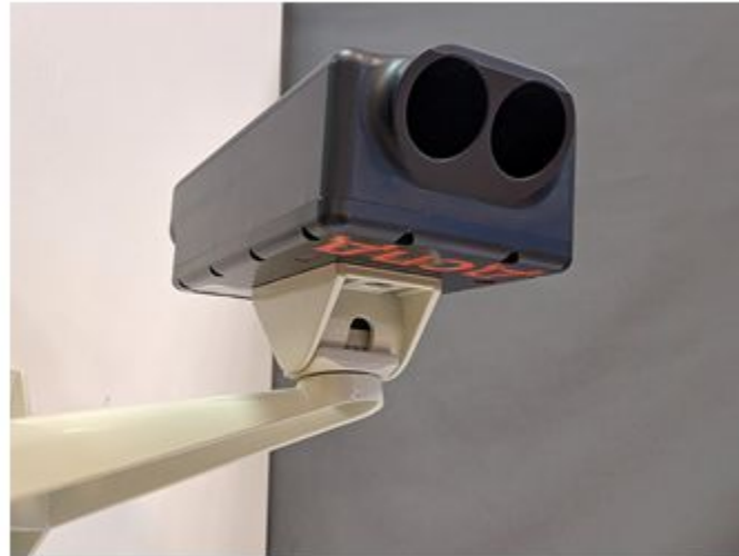
Рис. 2. Общий вид датчика состояния поверхности дорожного полотна «ДСПД».
