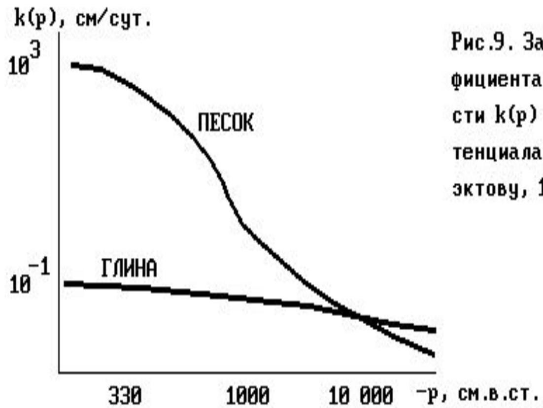
Рис.9. Зависимость коэффициента влагопроводности  $k(p)$  от водного потенциала  $P$  (по Р.А.Полухову, 1991).
