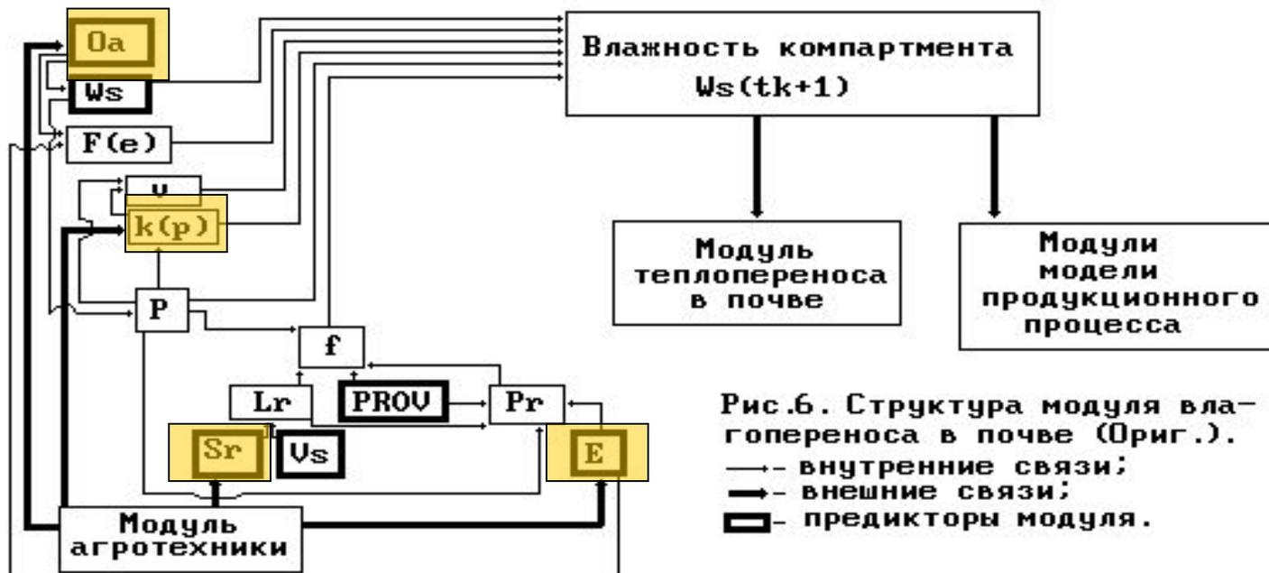
Рис.6. Структура модуля влагопереноса в почве (Ориг.).
