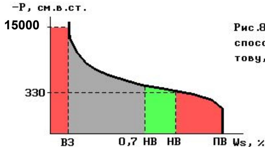
Рис.8. Кривая водоудерживающей способности почв (по Р.А.Полуэктову, 1991).
