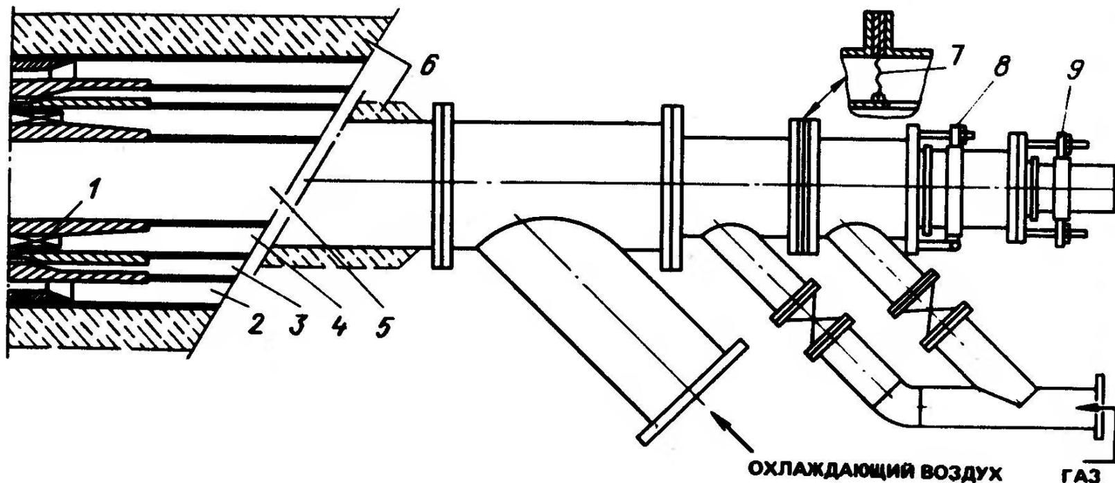
1 – завихритель; 2 – канал ввода мазутной форсунки; 3 – канал завихряемого потока газа; 4 – канал аксиального истечения газа; 5 – канал охлаждающего воздуха; 6 – жаростойкая изоляция; 7 – мембрана; 8 – узел регулирования щели аксиального канала; 9 – узел регулирования положения завихрителя
