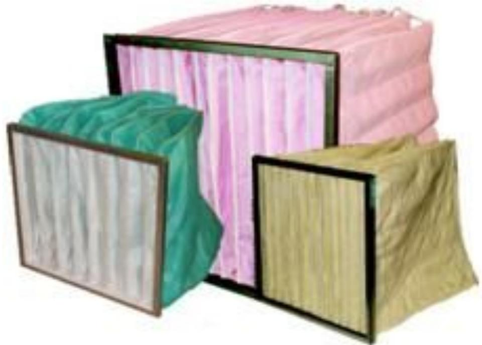
Фильтры ФяК (карманные) состоят из металлической рамки (1) и фильтрующего материала (2) в виде карманов. Противоположные поверхности карманов стянуты ограничителями (3), что препятствует сильному раздуванию и слипанию смежных карманов. Для фиксации расположения карманов под напором воздушного потока, они связываются между собой при помощи тесьмы.
