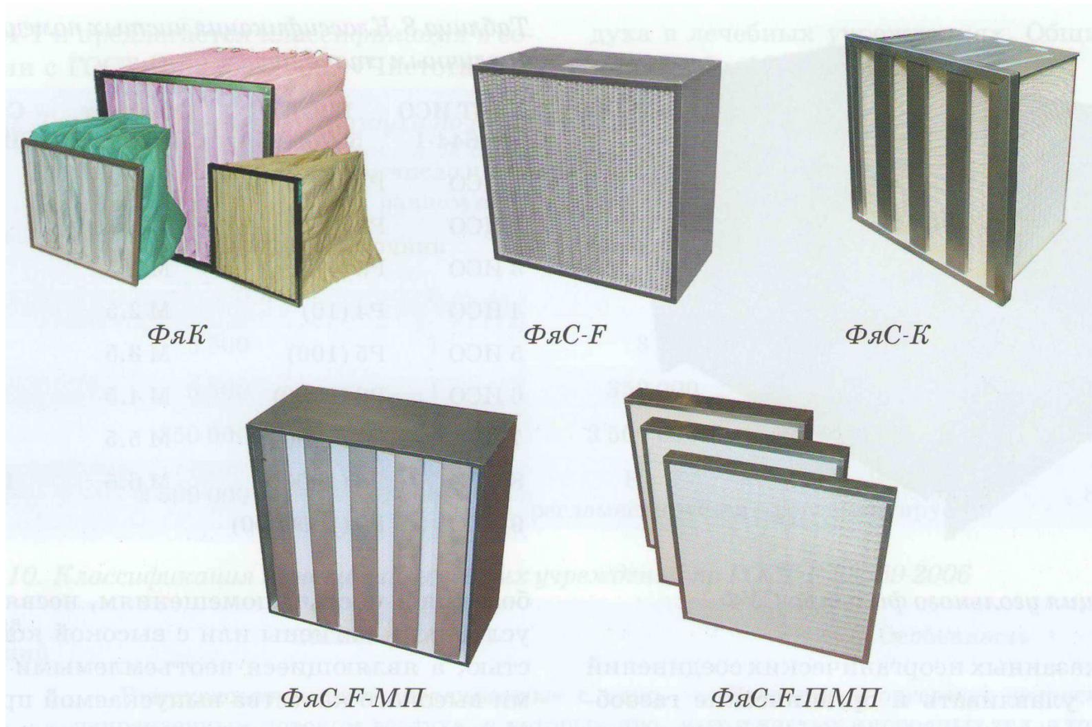
Фильтры ФяС состоят из корпуса, внутри которого складками уложен фильтрующий материал. Для предотвращения слипания соседних складок между ними прокладываются сепараторы из алюминиевой фольги или специальные нити, наклеиваемые на поверхность фильтрующего материала.
