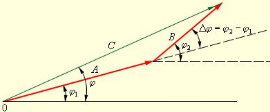
Изображение гармонических колебаний  $A \cos(\omega t + \varphi_1)$ ,  $B \cos(\omega t + \varphi_2)$  и их суммы  $C \cos(\omega t + \varphi)$  с помощью векторов на векторной диаграмме.
