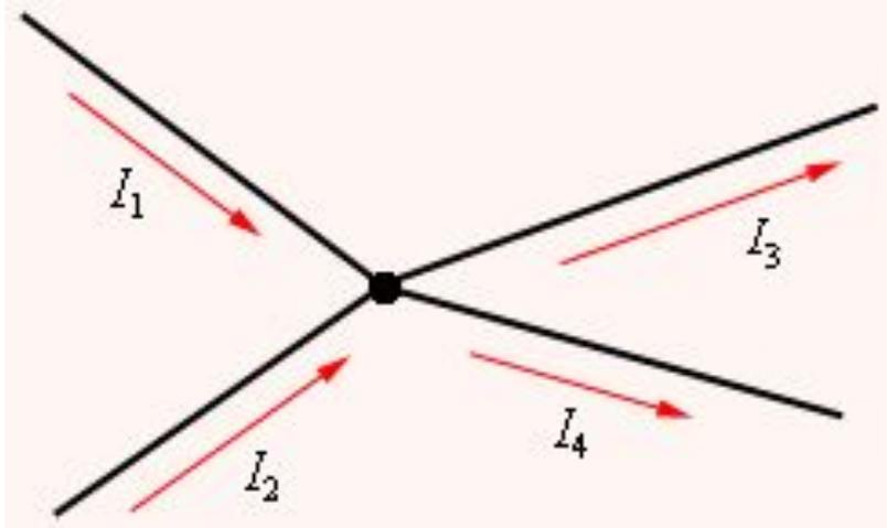
В ветвях, образующих узел электрической цепи, алгебраическая сумма токов равна нулю.  $\sum I = 0$ .
