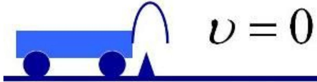
Станет ли двигаться тележка, если упругая пластинка выпрямится? Для этого перережем нить. Пластинка выпрямится. Тележка же останется на прежнем месте.
