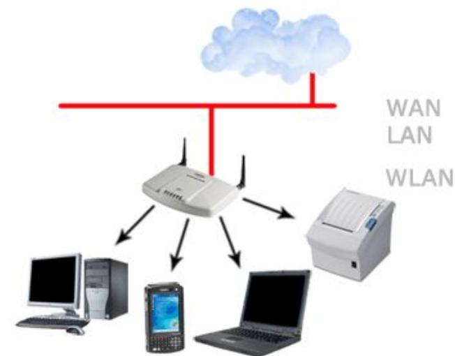
Создание новой беспроводной сети начинается непосредственно с конфигурации точки доступа - беспроводного маршрутизатора (роутера) подключения к ней компьютеров и другого беспроводного оборудования.
