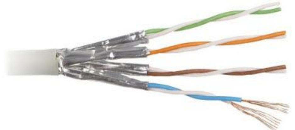
**Screened Foiled twisted pair (S/FTP, фольгированная экранированная витая пара).** Каждая пара этого кабеля находится в собственной оплетке из фольги, и все пары помещены в медный экран:
