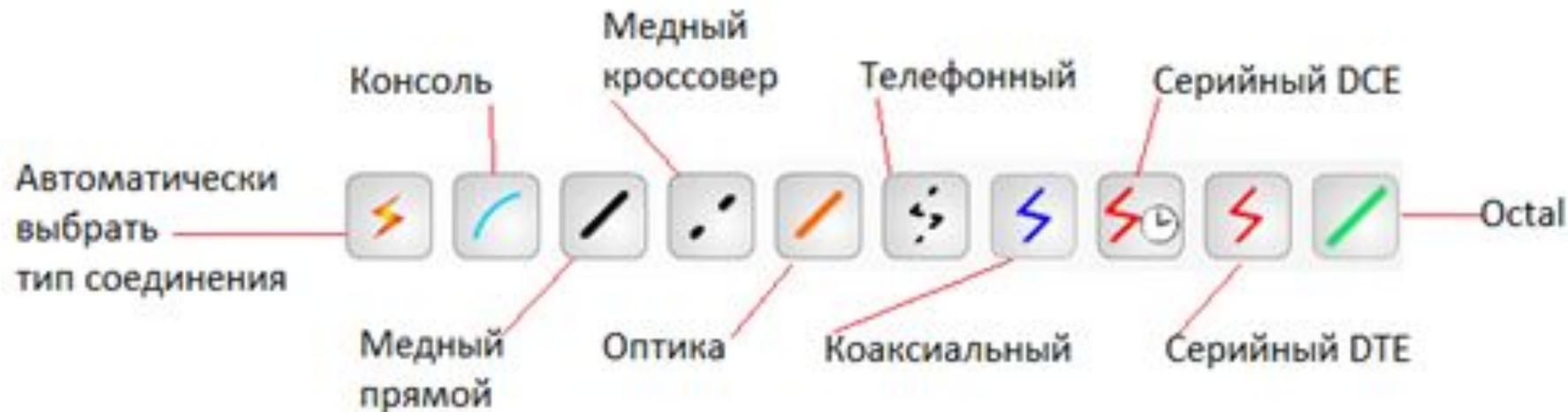
**Медь прямой** – соединение медным кабелем типа *витая пара*, оба конца кабеля обжаты в одинаковой раскладке.
