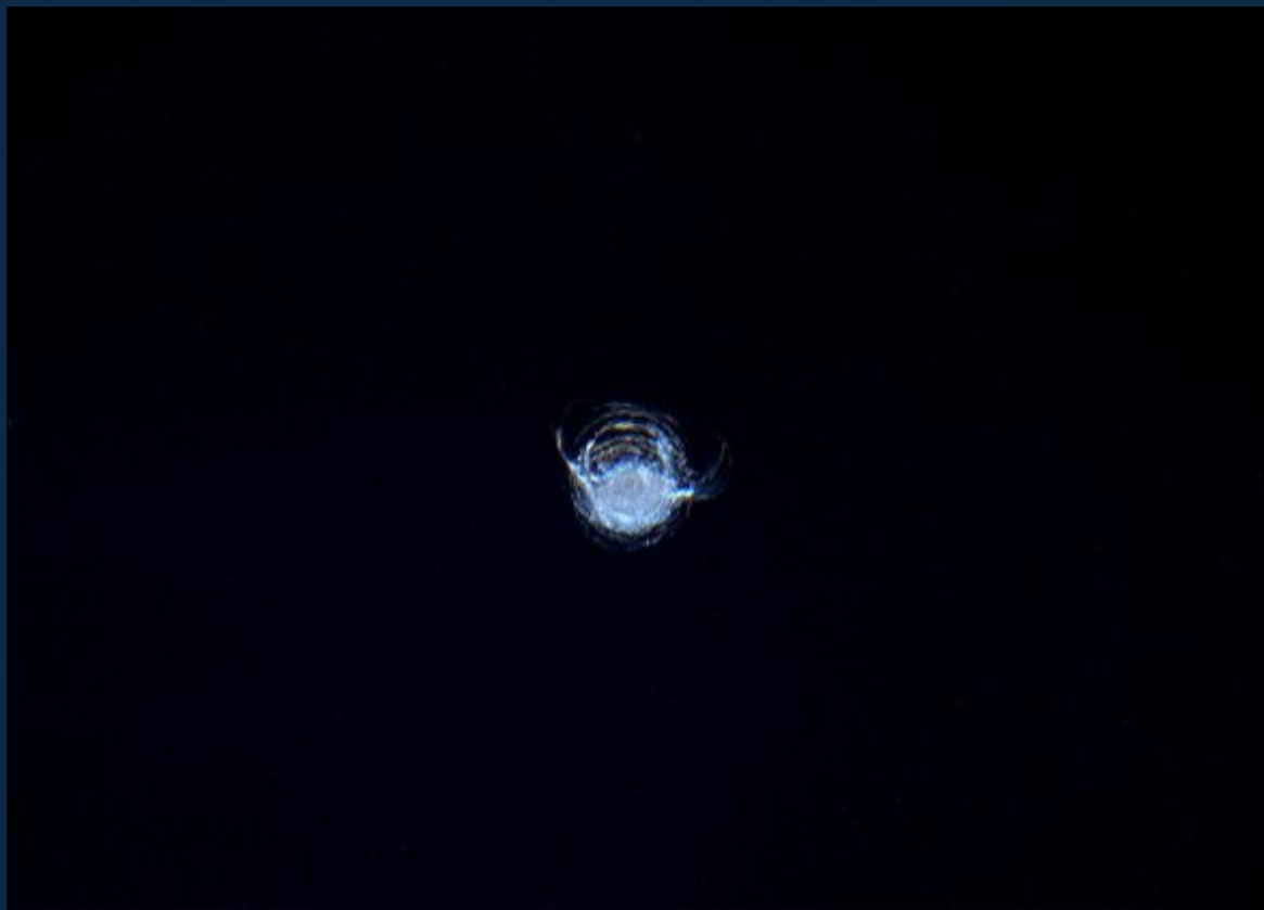
Скол на иллюминаторе МКС, 2016 год (Фото: ESA)
