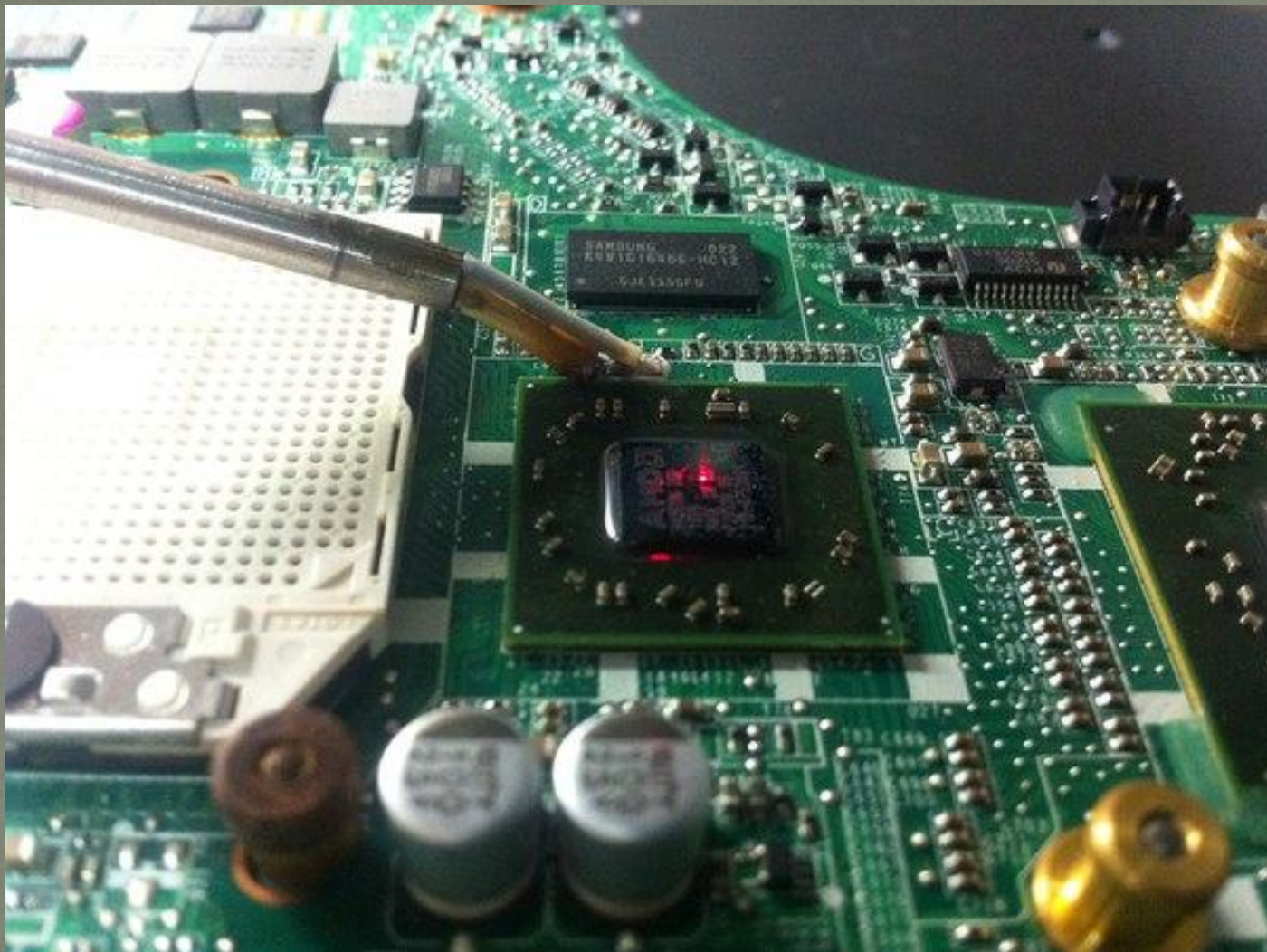
Пайка BGA воздухом
