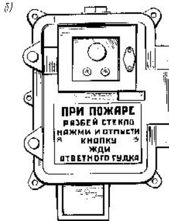
Рис. Пожарные извещатели: а - автоматический; б - ручной.
