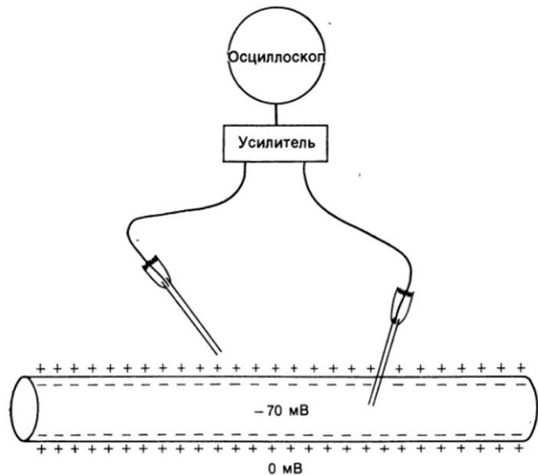
Рис. 4.2. Внутриклеточное измерение мембранного потенциала аксона. Величина усиленного потенциала регистрируется при помощи осциллоскопа.
