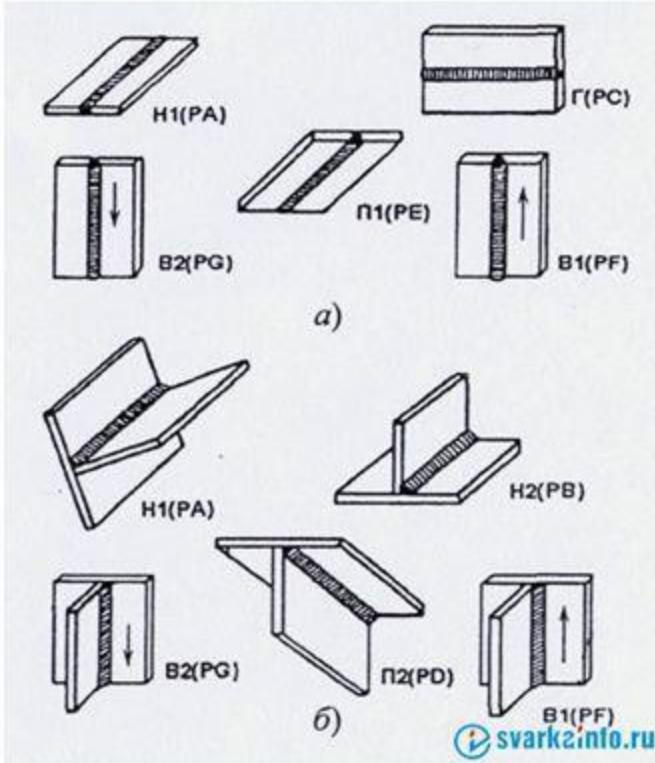
**Положение шва при сварке стыковых (а) и тавровых (б) соединений листов:**
