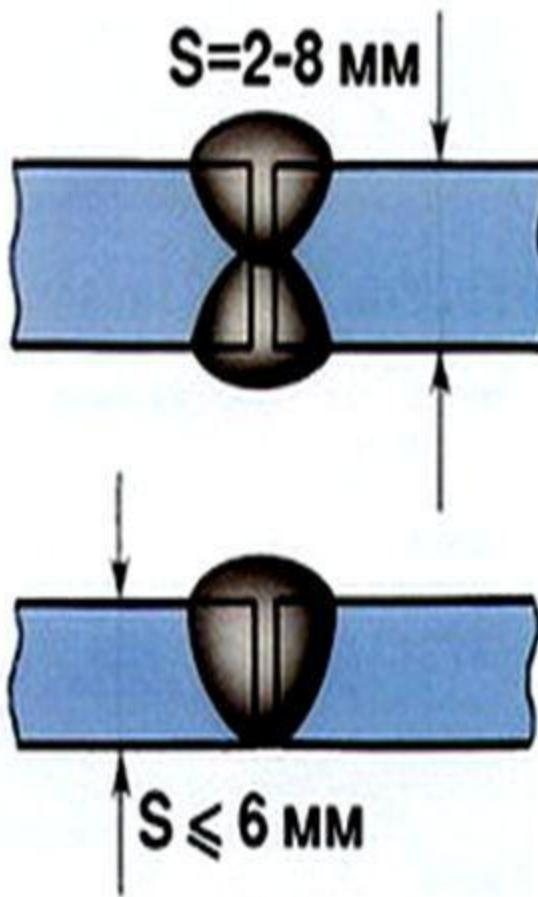
Металл толщиной более 8 мм сваривают с разделкой кромок. Во избежание прожогов сварку ведут на съемных медных или стальных подкладках
