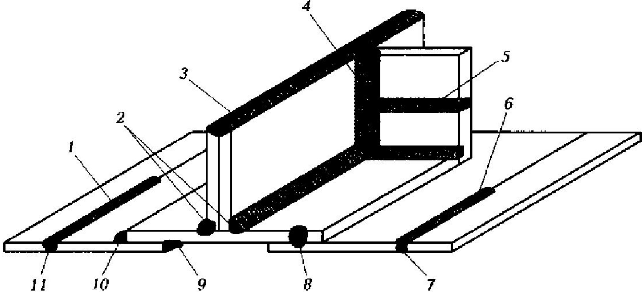
Рис. 2.26. Положение в пространстве различных видов сварных швов:
