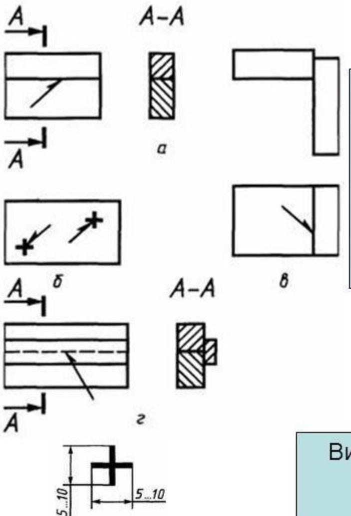
Шов сварного соединения,
