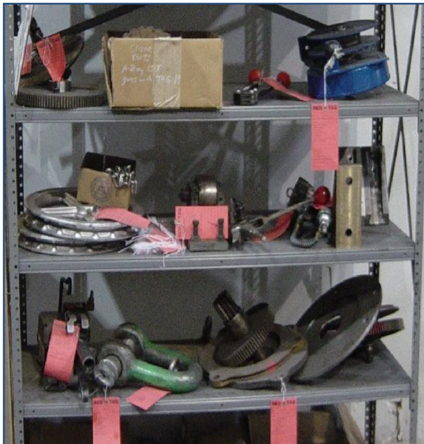
1. Обозначить ярлыками все предметы, по которым следует принять решение с целью определения частоты их использования
