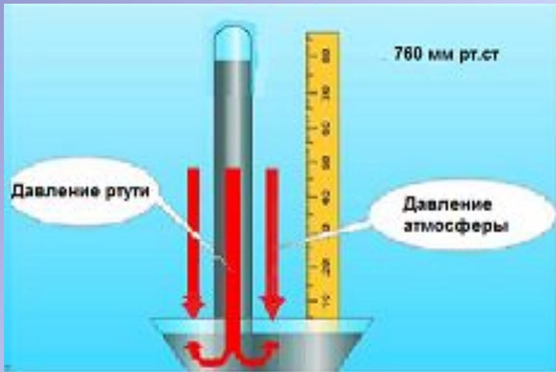
При опрокидывании трубки в сосуд с ртутью. Ртуть из трубки выливалась не полностью, а останавливалась на некоторой высоте, на отметке 760 мм, потому что воздух давит на ртуть в тарелке. И эта ртуть не дает выливаться ртути из трубки
