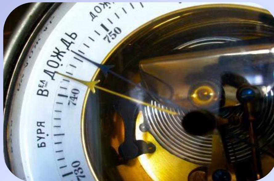
Главной частью его является упругая металлическая коробочка. Из неё выкачан воздух, поэтому она чувствительна к изменению давления снаружи. При понижении давления - расширяется, при повышении сжимается. Эти колебания с помощью прикрепленной к коробочке пружины передаются стрелке, которая по шкале показывает атмосферное давление в мм. рт. стб.
