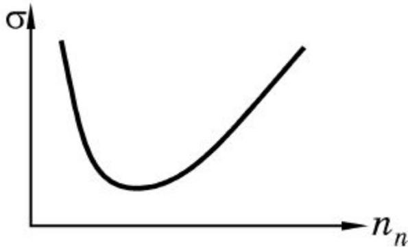
Зависимость удельной проводимости примесного полупроводника от концентрации электронов
