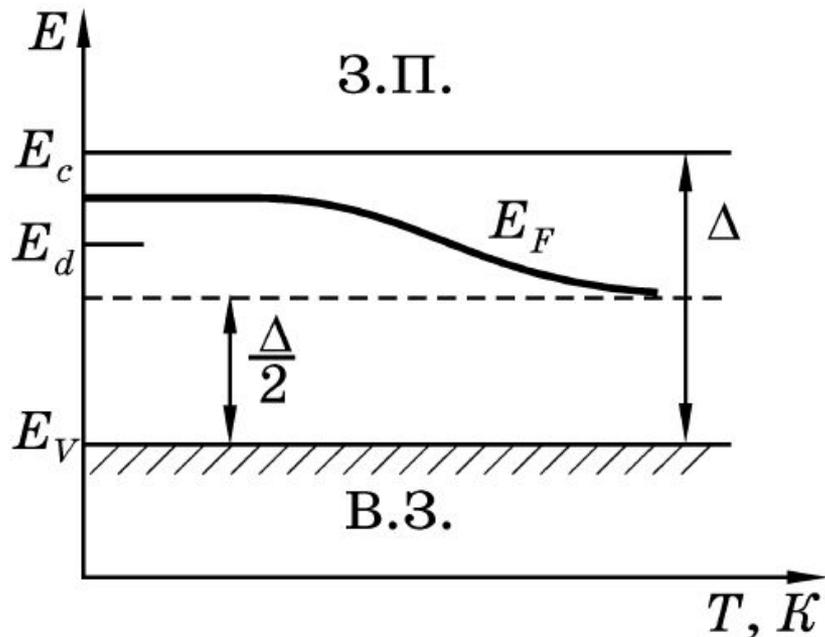
Зависимость энергии Ферми  $E_F$  от температуры для полупроводника n-типа
