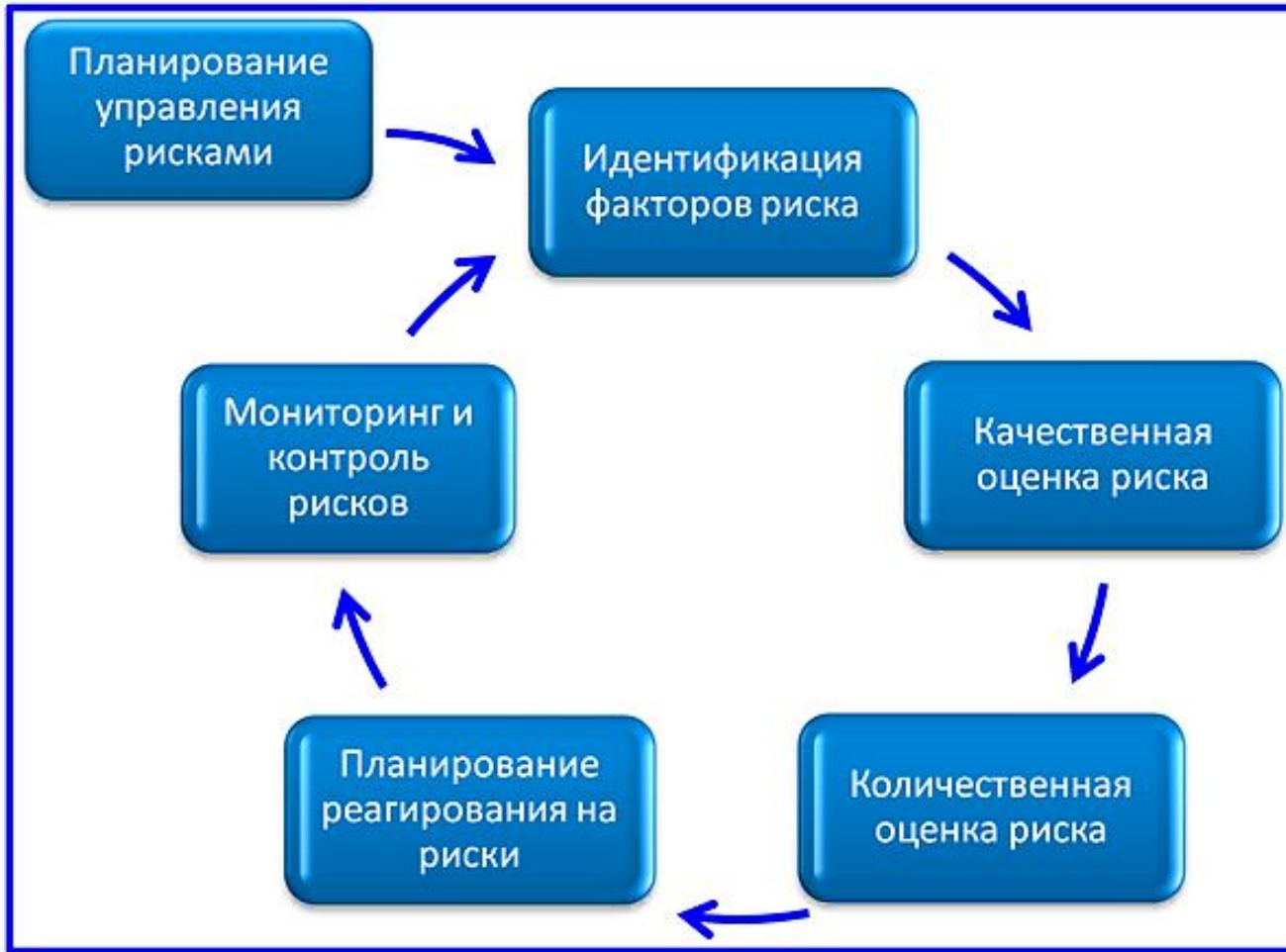
Схема процессов управления проектными рисками по PMBOK
