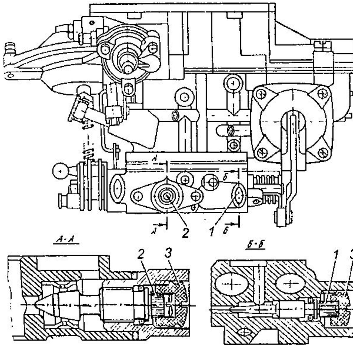
Регулировочные винты в карбюраторе типа «Озон»:
