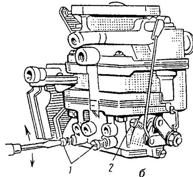
Положения отверток при регулировке карбюратора в режиме холостого хода:
