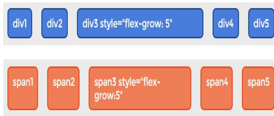
Рис. 9. Растяжение flex-элементов в строке
