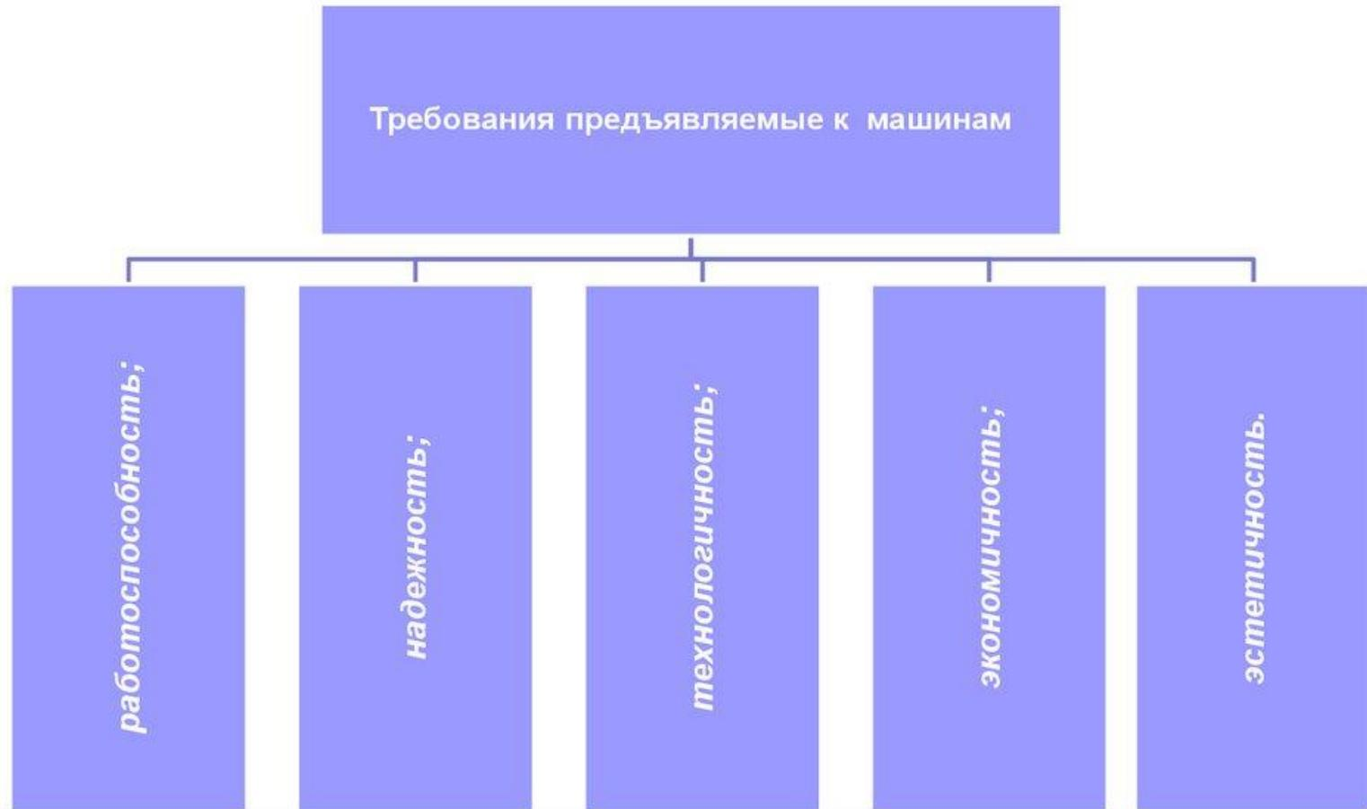
**Работоспособность** это такое состояние машины, при котором она может выполнять заданные функции в пределах технических требований
