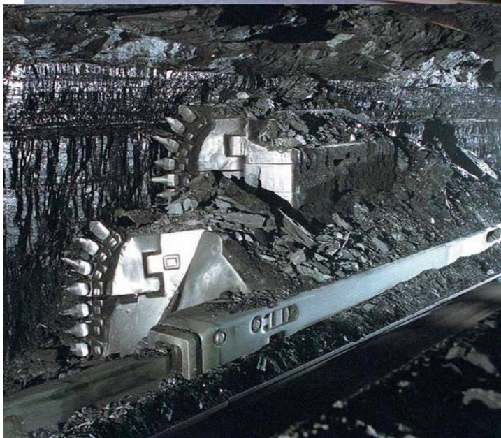
Струговая установка — выемочная машина, позволяющая механизировать выемку пластов, не охватываемых узкозахватными комбайнами, повысить технику безопасности и эффективность работы очистных забоев. Вдоль забоя машина перемещается с помощью каната или цепи при механизме подачи, встроенном в машину.
