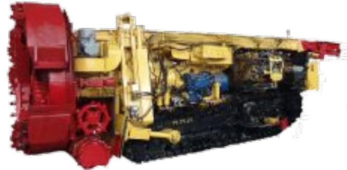
Основное назначение исполнительных органов выемочных машин – эффективно разрушать массив угля на транспортабельные куски с наименьшими измельчением, пылеобразованием и удельным расходом энергии. На врубовых машинах применяются баровые исполнительные органы, на струговых установках — струговые, при этом все исполнительные органы выемочных машин приводятся в движение с помощью [электрических двигателей](#).
