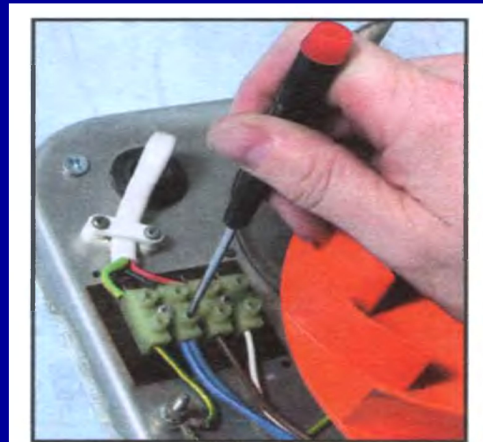
Обязательно затягивайте винты достаточно плотно
