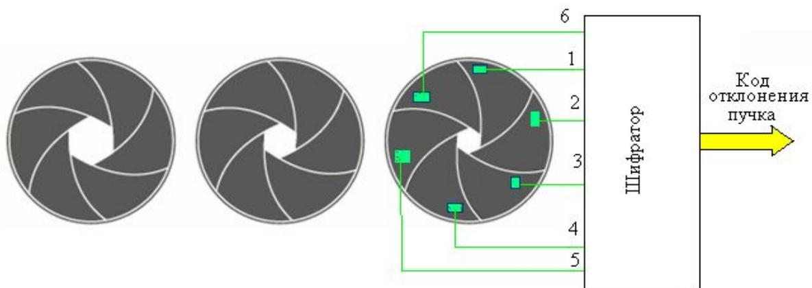
Рис. 5(б) – датчик отклонения пучка
