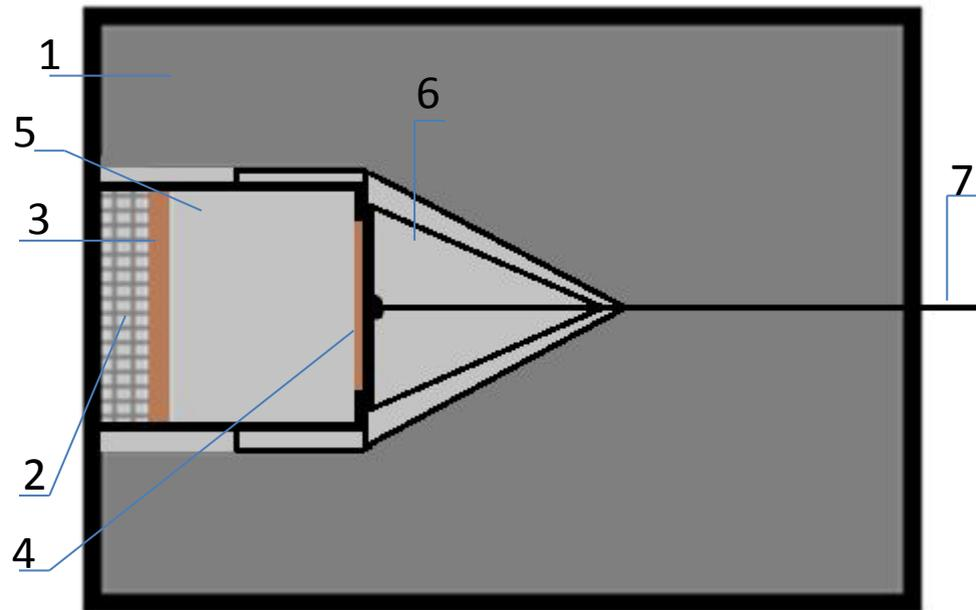
Рис. 6 – схема радиационно-акустического сенсора
