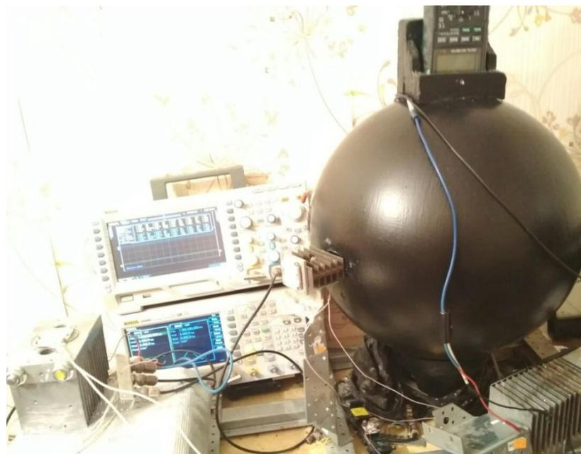
1– интегрирующая сфера; 2 – экран; 3 – СД (СДМ); 4 – эталонный СД с радиатором; 5 – фотометрическая головка люксметра «ТКА-Люкс; 6 – блок обработки сигналов люксметра «ТКА-Люкс; 7 – блок стабилизации заданного температурного режима СД; 8 – коммутационное устройство с усилителем мощности; 9 – источник постоянного тока; 10 – генератор Rigol DG 4062; 11 – осциллограф Rigol DS 2072; 12 – фотодиод ФД-7К; 13 – персональный компьютер (ПК)
