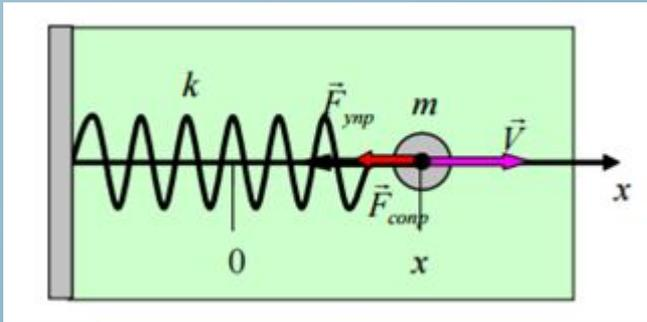
Если убыль энергии не восполняется за счёт работы внешних сил, колебания будут затухать. При этом механическая энергия переходит в теплоту. Механическая модель системы, совершающей затухающие механические колебания, приведена на рисунке: материальная точка массой  $m$ , колеблющаяся в вязкой среде под действием упругой  $F_{упр}$  (или квазиупругой) силы и силы сопротивления  $F_{сопр}$  вдоль некоторой оси  $x$ .
