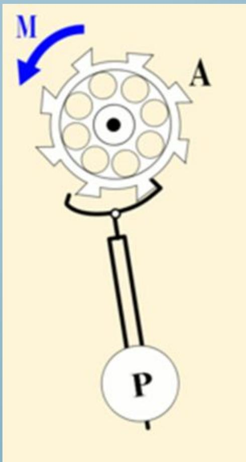
На рисунке показана схема механизма маятниковых часов. На ось храпового колеса А (которое в этой системе выполняет функцию нелинейного регулятора) действует постоянный момент силы М, передающийся через зубчатую передачу от заводной пружины или от гири. При вращении колеса А его зубцы сообщают кратковременные импульсы силы маятнику Р (осциллятору), благодаря которым его колебания не затухают.
