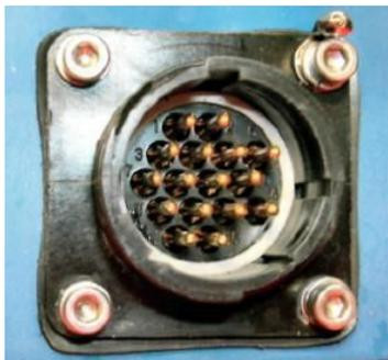
Проверьте штырьки кабеля ввода/вывода на предмет повреждений. Убедитесь, что они не изогнуты и на металлических поверхностях нет следов коррозии. Проверьте датчик StreamPro на предмет повреждений. Не должно быть выщерблин, зубцов, царапин или отслаиваний. Проверьте:
