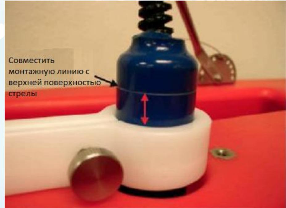
Для положения "в корпусе", датчик должен быть вставлен в рычаг так, чтобы линия совпала с верхом стрелы. Это гарантирует, что датчик утоплен приблизительно на 5 мм. Это помогает защищать датчик; он не будет поврежден, если его протащить по грунту
