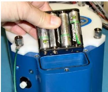
Выключите питание. Удалите солнцезащиту (если установлена). Удалите крышку батарейного отсека, ослабив три винта. Удалите держатель батарей. Удалите старые батареи. Вставьте 8 новых алкалиновых батарей AA. Соблюдайте полярность батарей, как указано на панели батарей. Поместите панель батарей в корпус, убедившись, что контакты батарей на панели соответствуют двум пружинам в корпусе.
