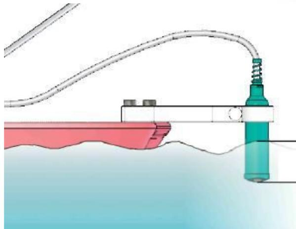
Для расширенной позиции, отрегулируйте глубину датчика так, чтобы он был на три – шесть сантиметров ниже поверхности воды. Затяните винты на зажиме, чтобы закрепить датчик.
