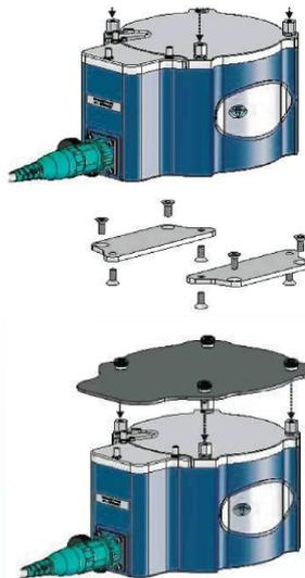
**Корпус электроники.** Прикрепите монтажные поверхности к корпусу электроники, используя четыре винта с плоской головкой. Разъем кабеля в/в должен быть направлен к носу поплавок.
