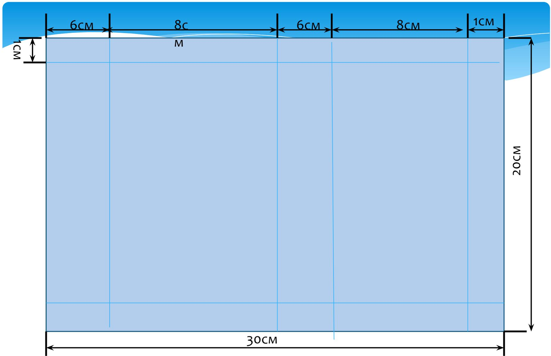
Этот чертеж – развертка будущего дома. Нужно выполнить разметку его стен.
