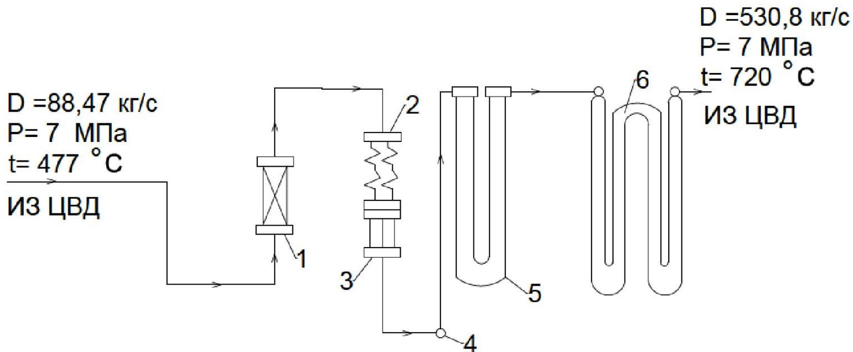
1 – экраны ограждения правого газохода; 2 – первая регулируемая ступень КПНД1; 3 – отводящие трубы КПНД1; 4 – нижний коллектор; 5 – ШНД2; 6 – КПНД3
