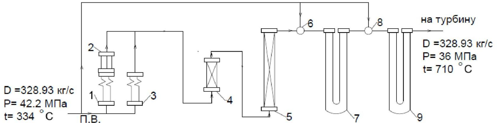
1 – экономайзер правой конвективной шахты; 2 – подвесные трубы; 3 – экономайзер левой конвективной шахты; 4 – экраны ограждения левого газохода; 5 – топочная камера; 6 – впрыскивающий пароохладитель первой ступени; 7 – ШВД-1; 8 – впрыскивающий пароохладитель второй ступени; 9 – ШВД-2
