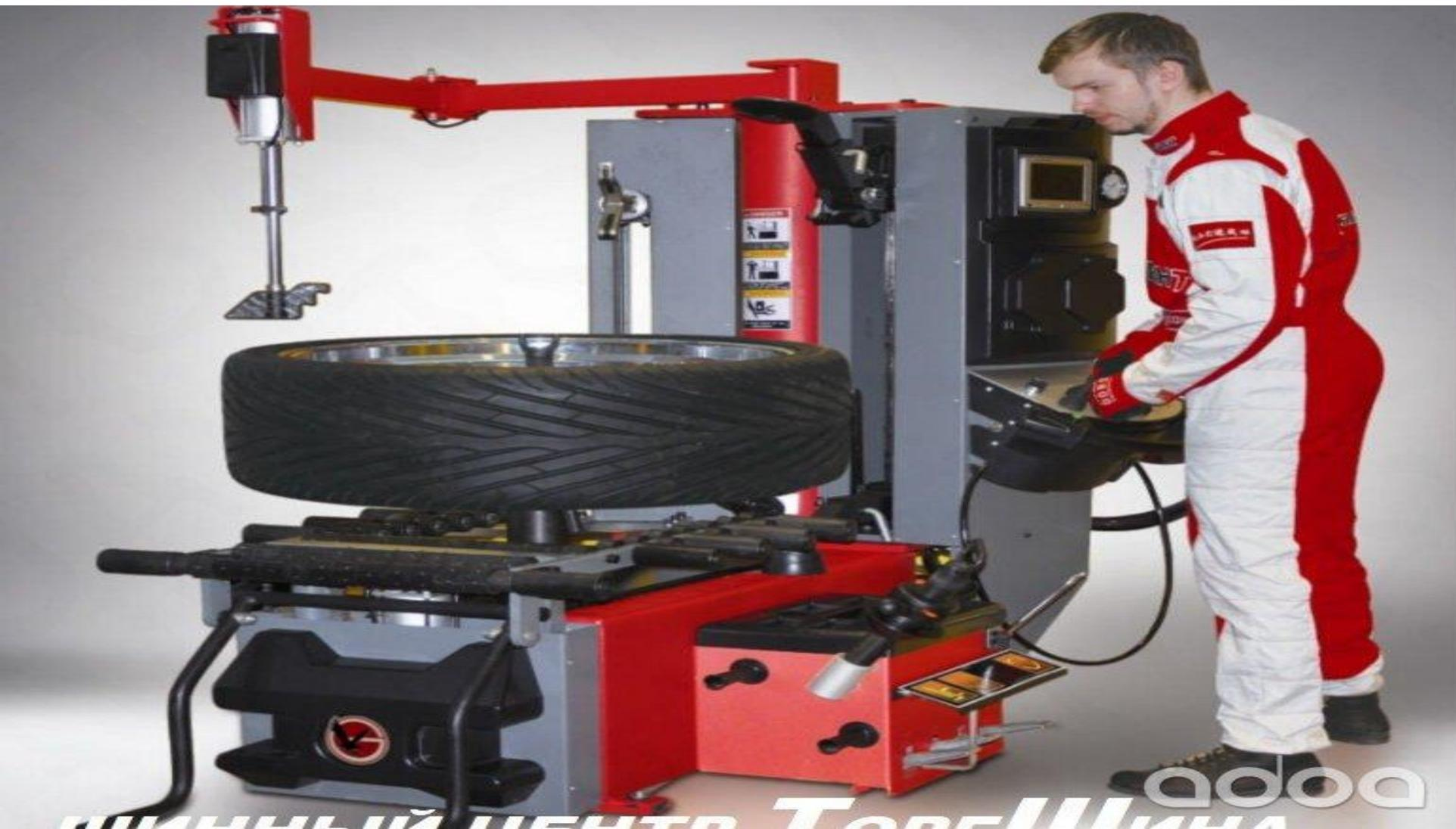
Для облегчения посадки и накачки бескамерных шин станды могут быть оборудованы системой быстрой подачи воздуха (взрывной накачкой) в шину и в зазор между бортом шины и ободом диска для создания нижнего воздушного запорного кольца
