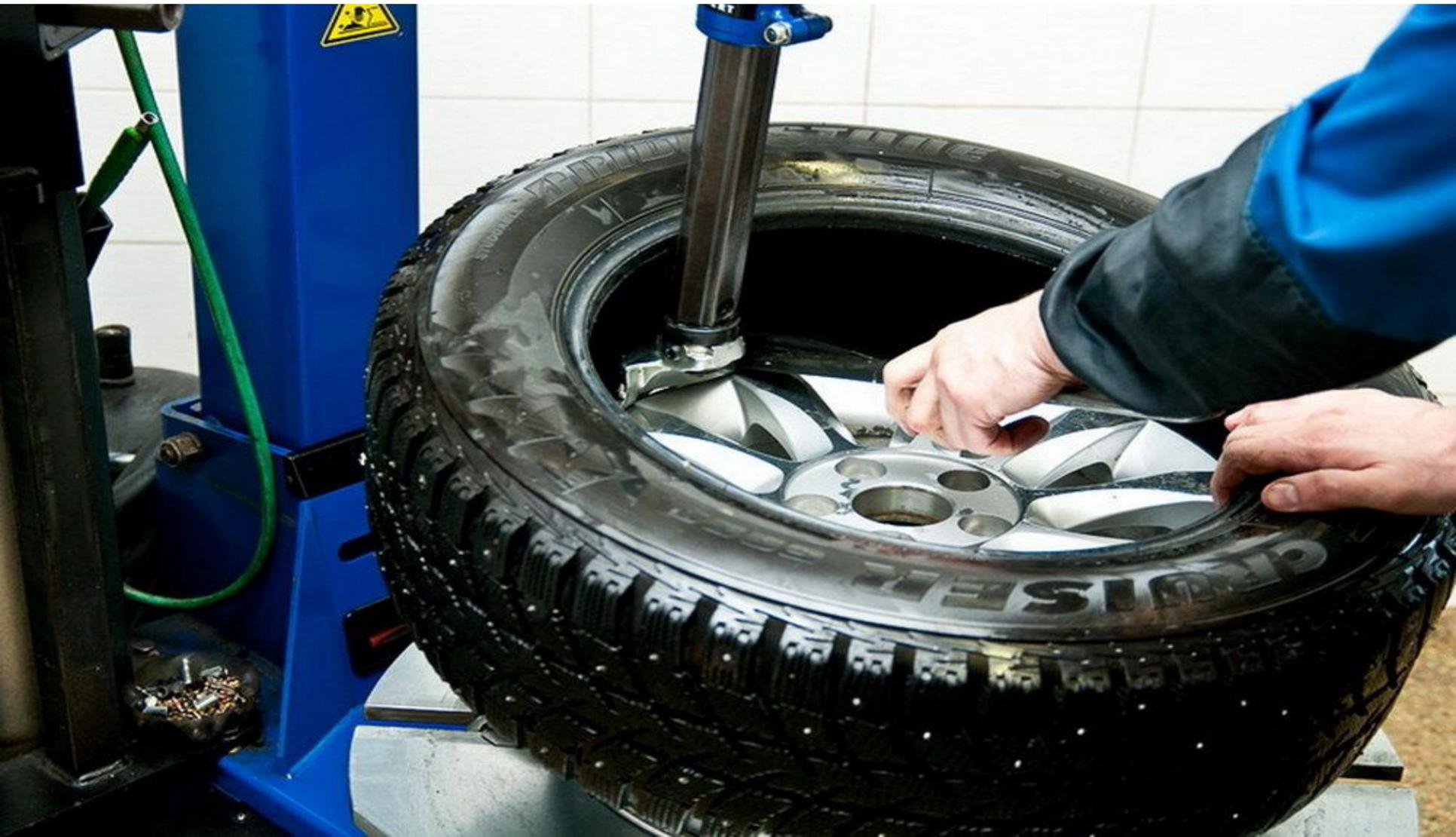
Пневматический цилиндр (в одних моделях — одностороннего действия с возвратом от пружины, в других — двустороннего действия) через систему консольных рычагов перемещает монтажную лопатку, которая давит на борт шины вертикально установленного около боковой стороны корпуса стенда колеса и отрывает его от диска. Управление механизмом осуществляется от педали
