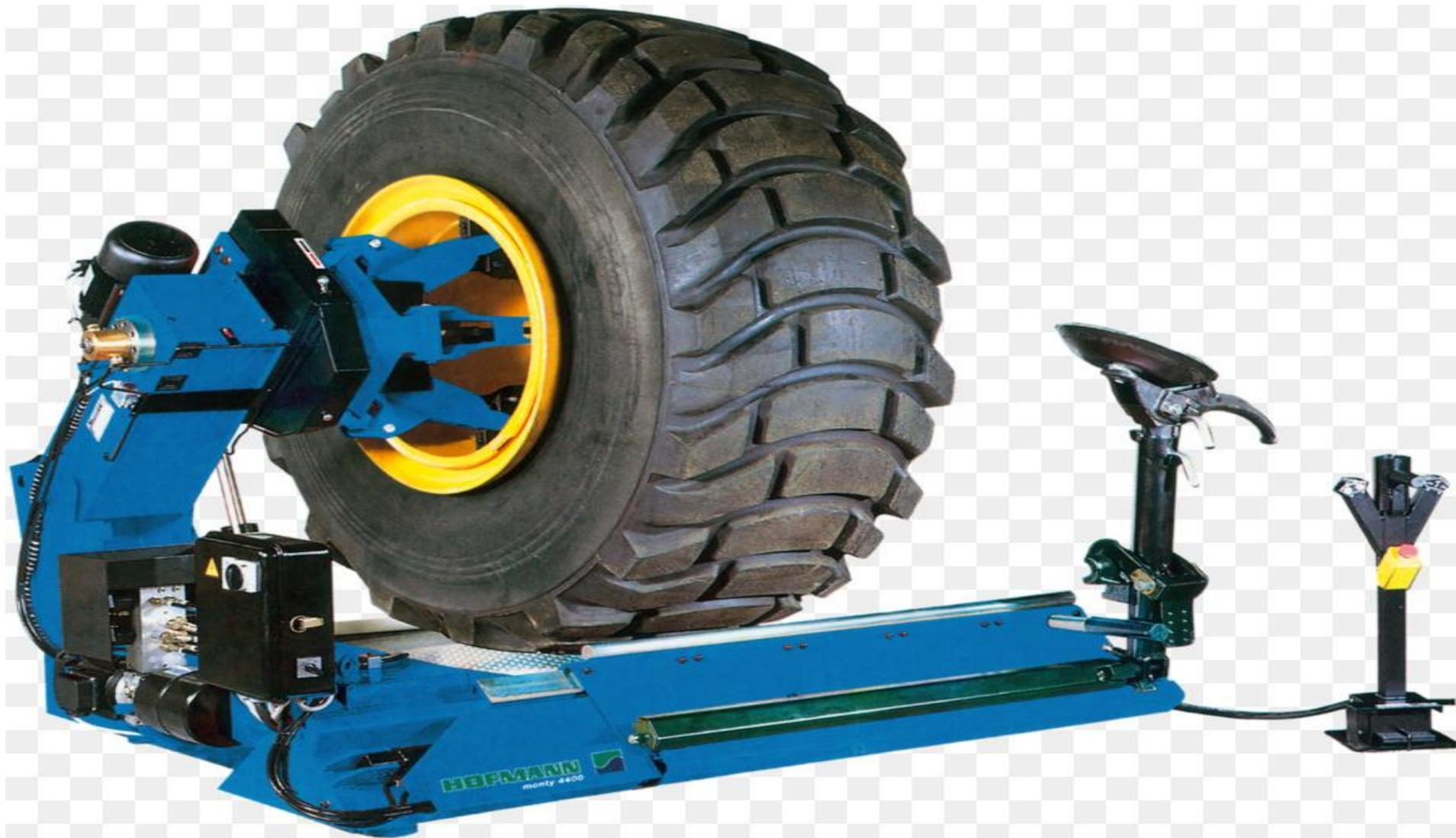
Рассмотрим устройство типового стенда для шиномонтажных работ с колесами легковых автомобилей. Стенд (рис. 2.93) выполнен по схеме «а — 1». Он имеет вертикальную компоновочную схему и состоит из корпуса, на котором смонтированы монтажный стол, колонна с монтажной консолью и дополнительные устройства
