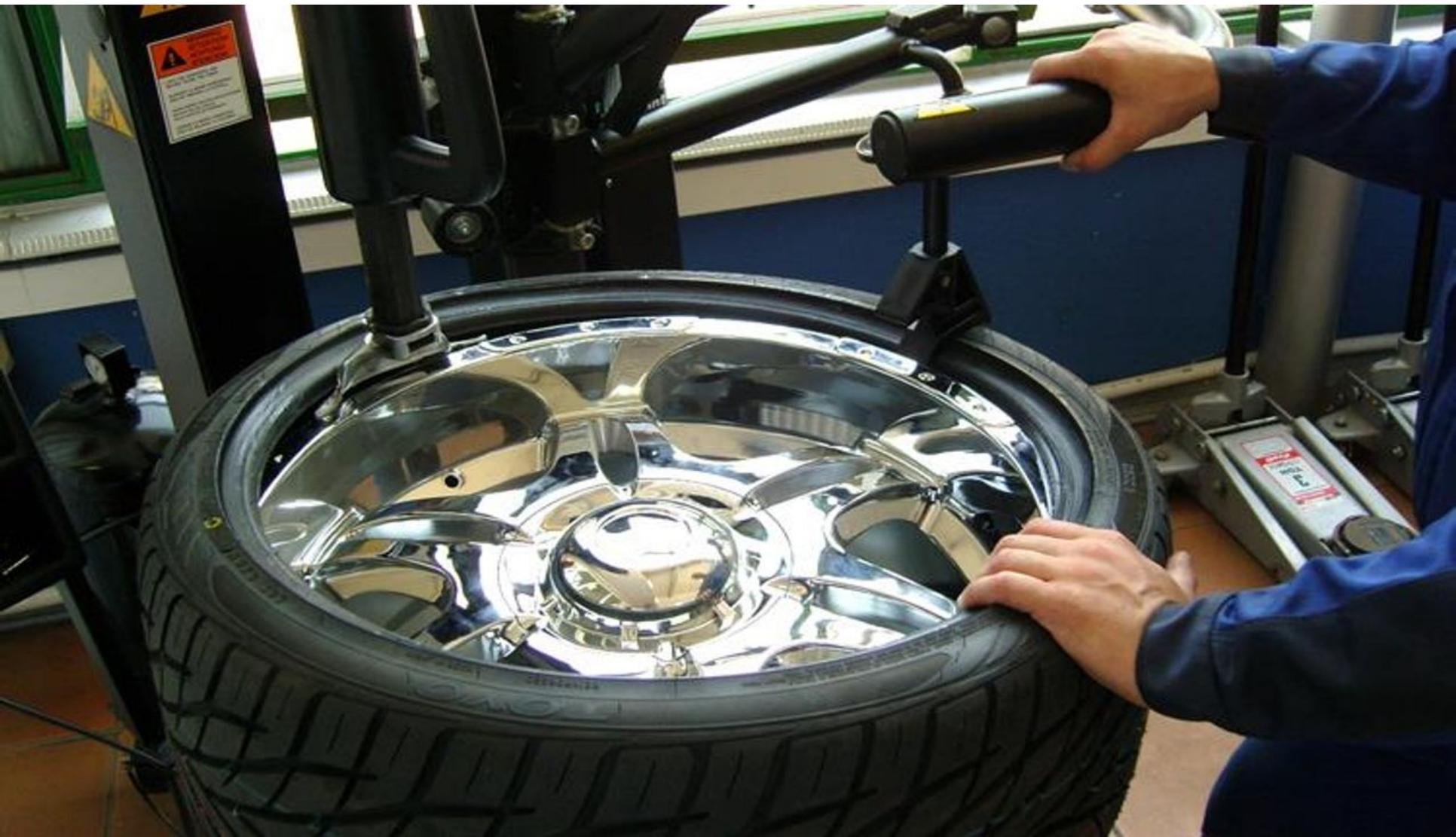
При работе на автоматических станках с откидной колонной для того, чтобы установить новое колесо на стенд, достаточно нажать на педаль и колонна уже с фиксированными положениями монтажной головки откинется назад. После установки нового колеса на стенд нажимается та же педаль и колонна возвращается в первоначальное рабочее состояние
