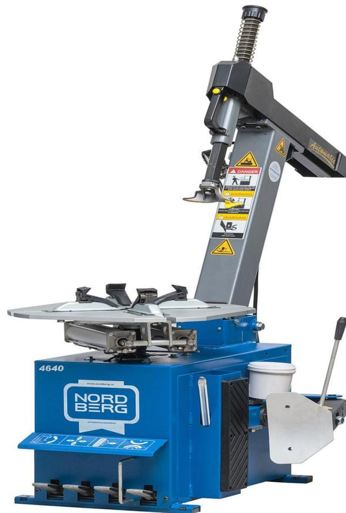
В полуавтоматических стандах лапка подводится вплотную к закраине диска и фиксируется верхним рычагом, при данной фиксации происходит одновременный подъем монтажной лапки вверх от диска на расстояние 1,5-2 мм — необходимый технологический зазор, предохраняющий диск от повреждения
