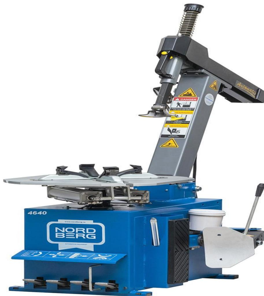
В автоматических станках с неподвижной колонной и подвижной консолью установка монтажной головки при смене колеса производится также двукратным нажатием на педаль, при этом штанга автоматически поднимется вверх и отведется назад подвижной консолью, а после установки нового колеса консоль и штанга вернуться в первоначальное состояние
