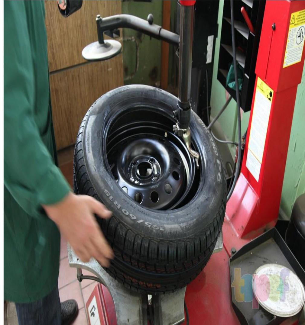
Монтажная колонна состоит из стойки, поворотной или выдвигной консоли и монтажной штанги с укрепленной на ее нижнем конце монтажно-демонтажной головкой. Монтажная головка может перемещаться вверх — вниз, фиксироваться в определенном положении с помощью рукояток и отклоняться в сторону вместе с КОНСОЛЬЮ
