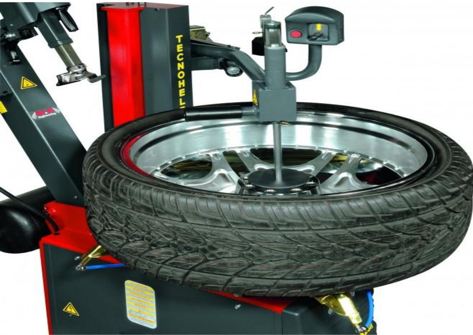
Эти устройства носят название «третья рука». Они смонтированы на жесткой стойке и включают в себя ряд рычажных механизмов, приводимых в действие вручную или от пневмопривода, с рабочими органами в виде дисков, лапок, конусных и цилиндрических валиков и др. (рис. 2.96).
