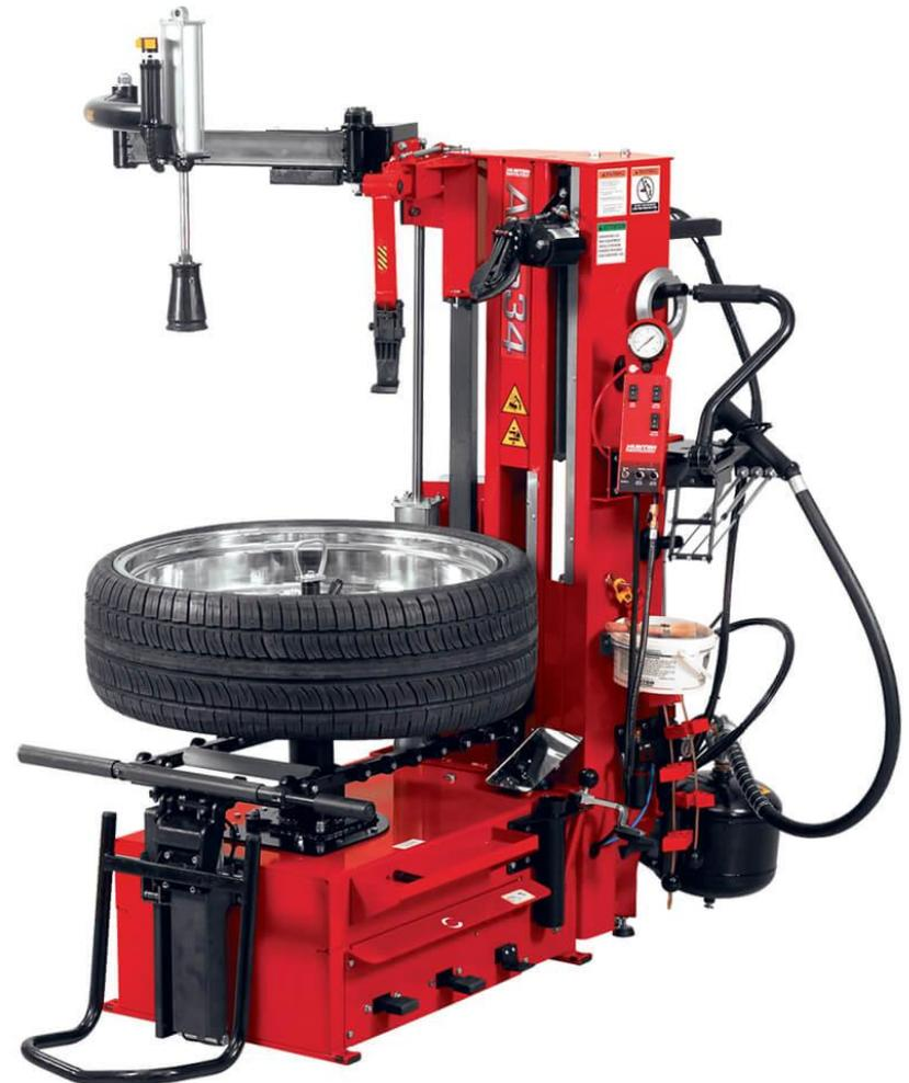
В одних моделях станков монтажная стойка неподвижно закреплена на корпусе, в других — для удобства работы имеет возможность отклоняться назад
