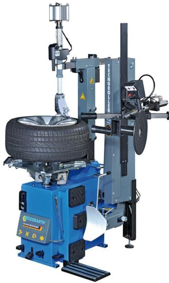
Для работы с разными конструкциями дисков автомобильных и мотоциклетных колес стенд комплектуется набором сменных кулачков различной высоты с металлическими и пластмассовыми губками (рис. 2.94).
