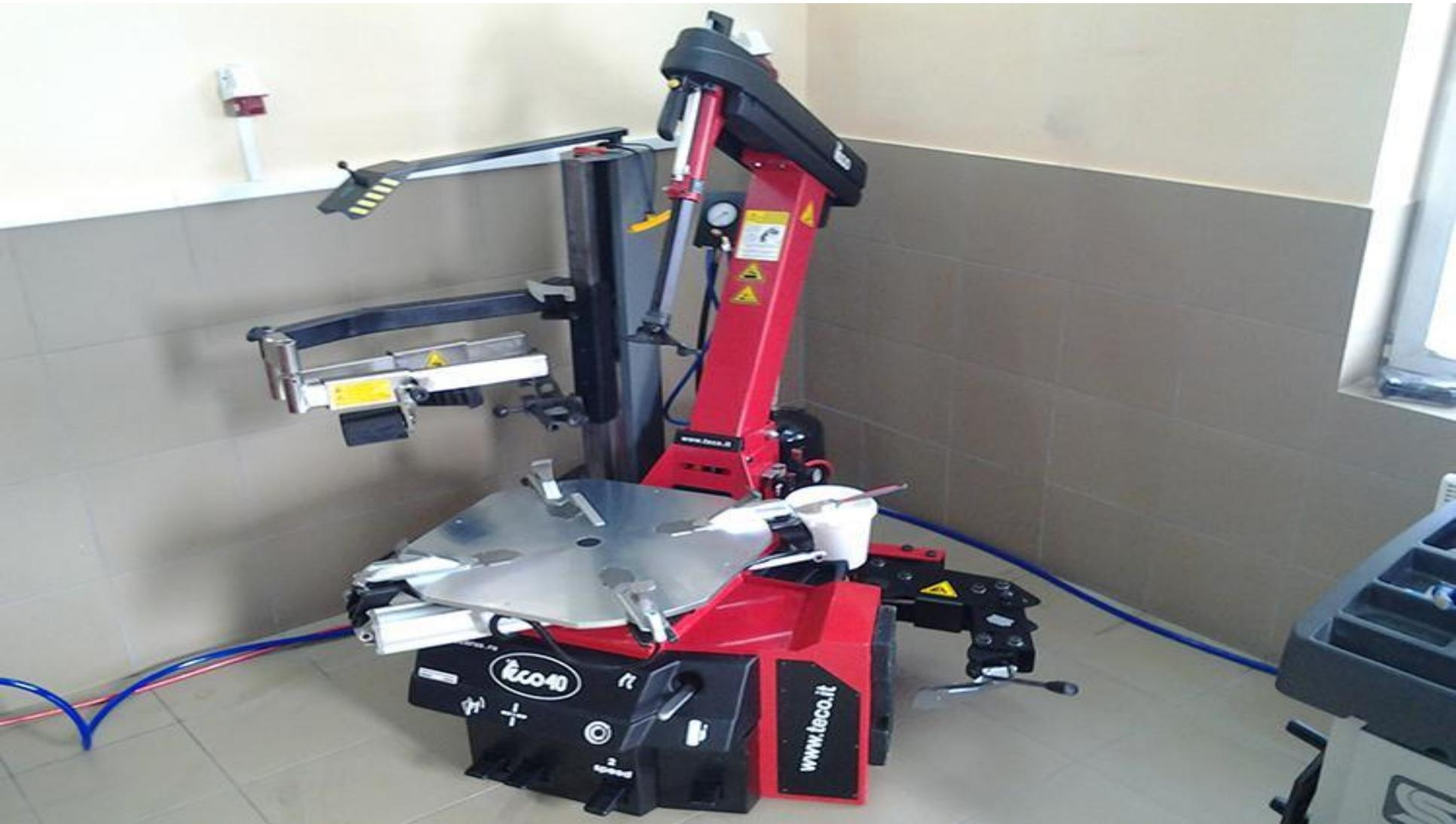
Перед демонтажем шины с диска ее отбортовывают, т. е. отжимают борт шины от диска. Механизм отжима — рычажный с пневматическим приводом. Рабочий орган механизма — монтажная лопатка
