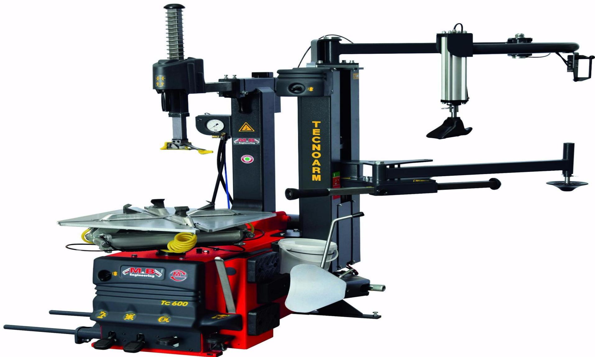
Монтажный стол имеет зажимное устройство в виде четырехкулачкового самоцентрирующегося патрона с приводом от двух пневматических цилиндров, что обеспечивает достаточное зажимное усилие. Пневматические цилиндры и рычажный механизм раздвигания кулачков закреплены на нижней плоскости стола
