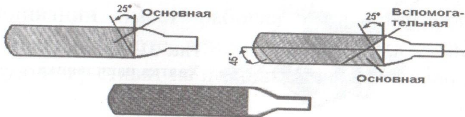
Рис. 30. Виды насечек напильника:
