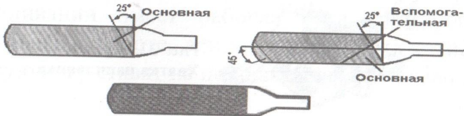
Рис. 30. Виды насечек напильника:
