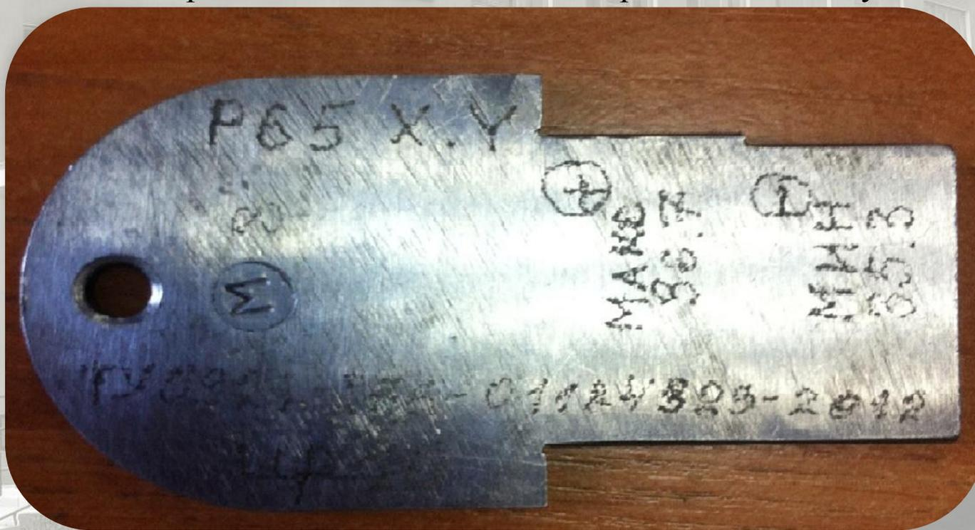
Шаблон для контроля болтовых отверстий рельса
