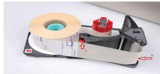
А – край ленты фиксируется ограничителем ширины
