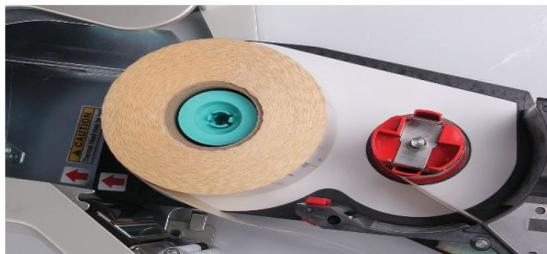
Совместить красные стрелки на кассете и на принтере, после чего задвинуть кассету в принтер до упора.
