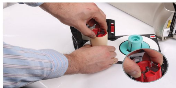
3. Удалить отработанную подложку
