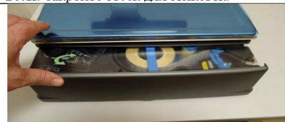
20. Выдача одной чистой этикетки - это тест правильности замены этикетки.
