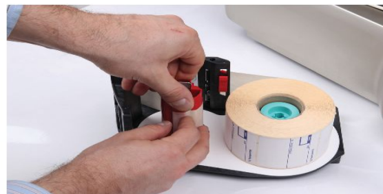
6. Повернуть вал смотчика на полтора-два оборота по часовой стрелке
