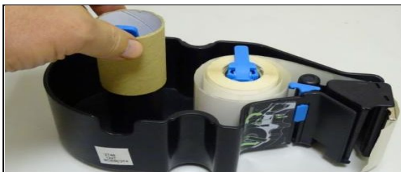
9. Удалите накопленный рулон основы и остатки картонной пыли.
