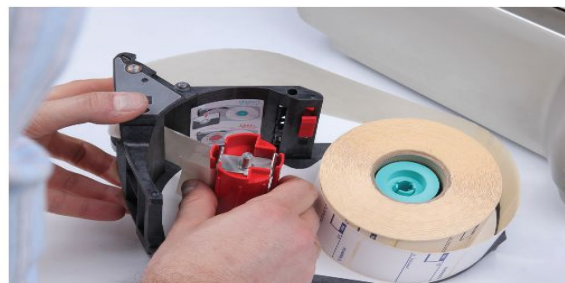
5. Протянув ленту к смотчику, зафиксировать ее конец на клипсе
