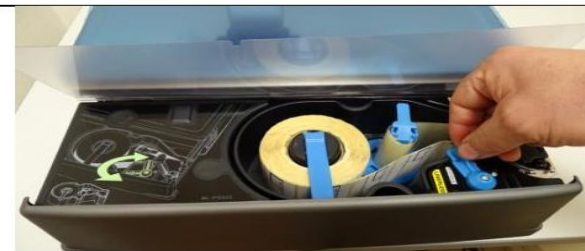
18. Кассета с новым рулоном установлена в весы. Закройте отсек для этикеток.
