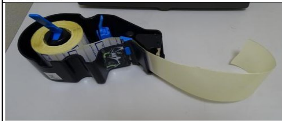
13. Опустите рычаг и намотайте на держатель весь свободный участок основы
