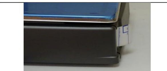
20. Выдача одной чистой этикетки - это тест правильности замены этикетки.
