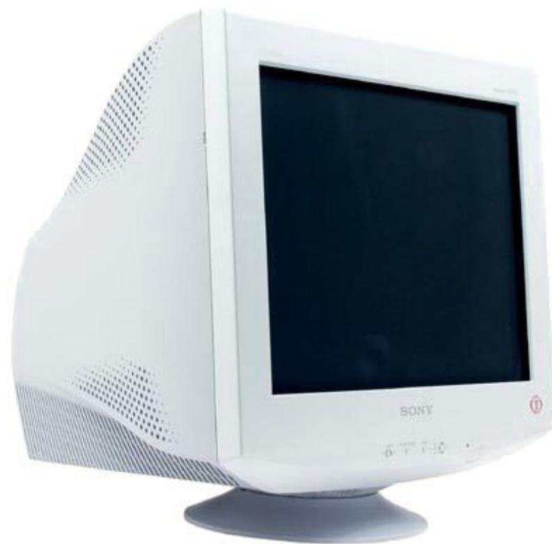
CRT-мониторы - самый распространенный тип. Как видно из названия, в основе всех подобных мониторов лежит электронно-лучевая трубка (ЭЛТ)
