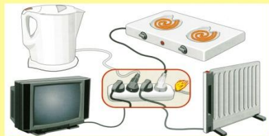
Неисправная электропроводка, электроизоляция, перегрузка электросети.
