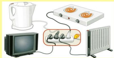
Неисправная электропроводка, электроизоляция, перегрузка электросети.
