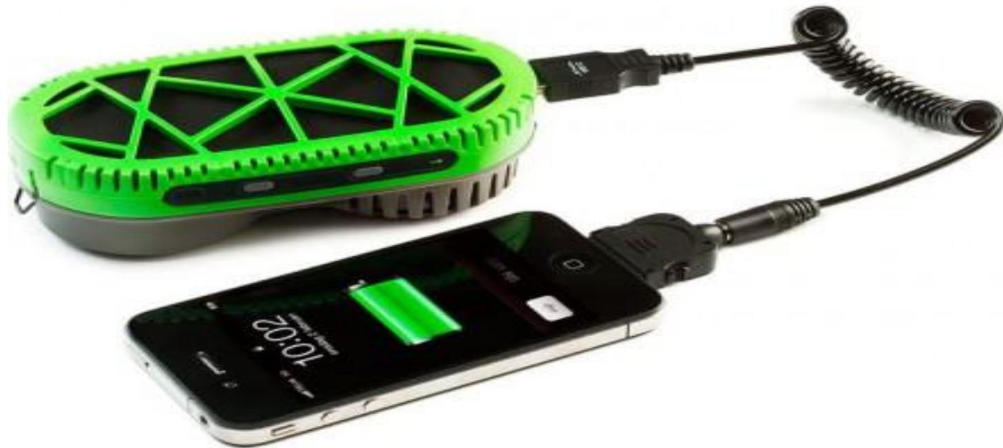
Принцип работы зарядного устройства очень прост, но эффективен. После того, как пользователь помещает топливный картридж в зарядное устройство и добавляет воду, она взаимодействует с его содержимым: кремниевым порошком и силицидом натрия. Реакция с водой выделяет водород, а водород, смешиваясь с воздухом, генерирует электричество через протонообменную мембрану.
