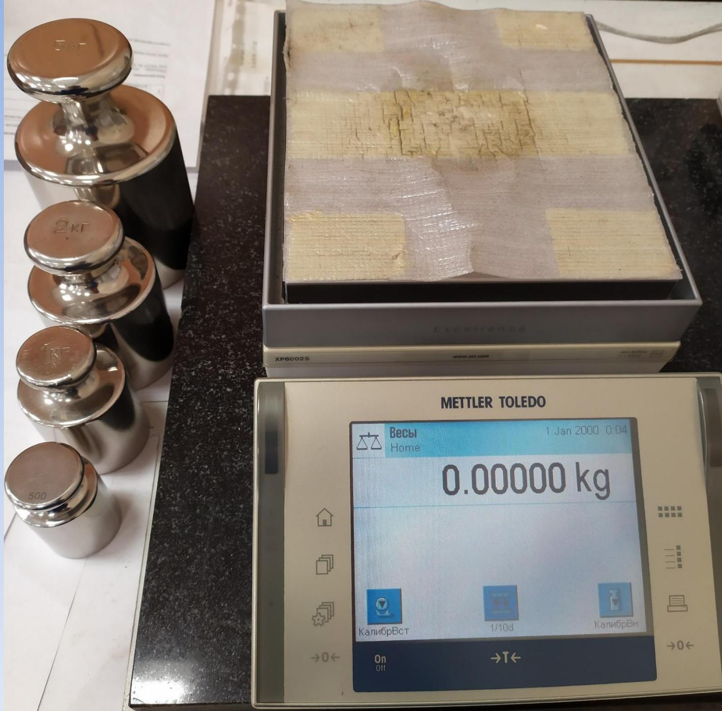
*Рисунок 4.а. Весы для взвешивания грузов и грузоприемной части.*
