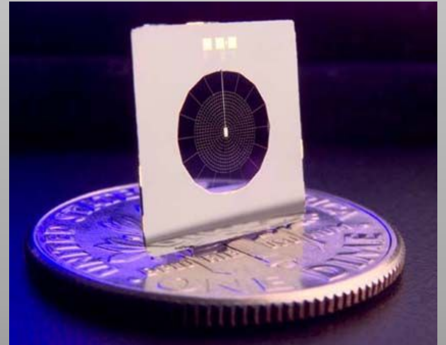
Паутиновый болометр для регистрации фонового космического излучения
