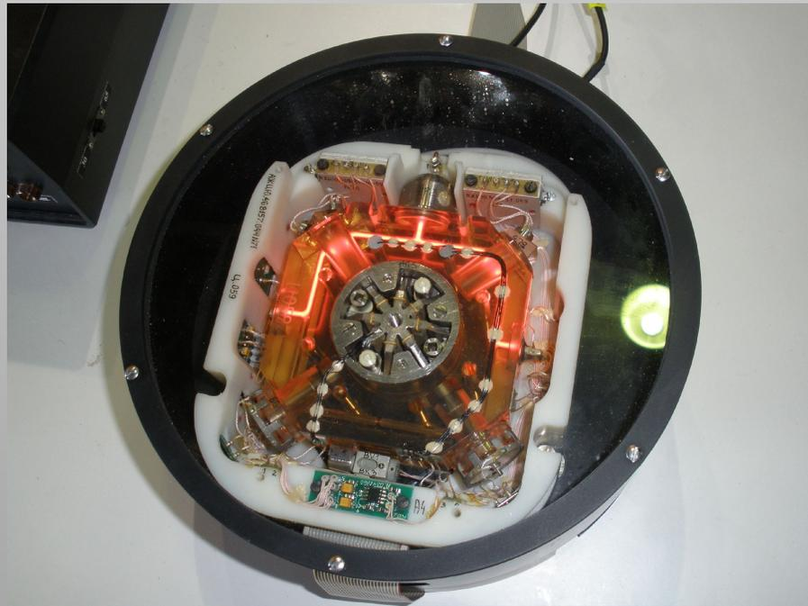
Кольцевой лазерный гироскоп производства украинского завода «Арсенал» в одном из павильонов авиасалона МАКС-2011. Резонатор имеет форму квадрата. В его центре расположен виброподвес.
