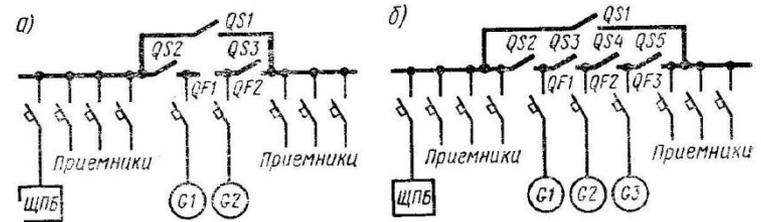
Схемы электростанций с секционированием шин:
