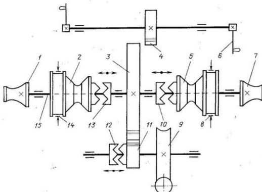
Кинематическая схема брашпиля с рукоятчным ручным приводом
