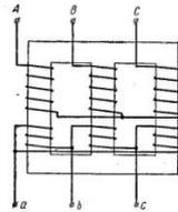
Рис. 8.17. Схема трехфазного трансформатора
