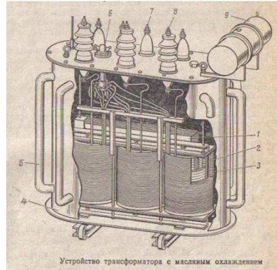
Устройство трансформатора с масляным охлаждением
