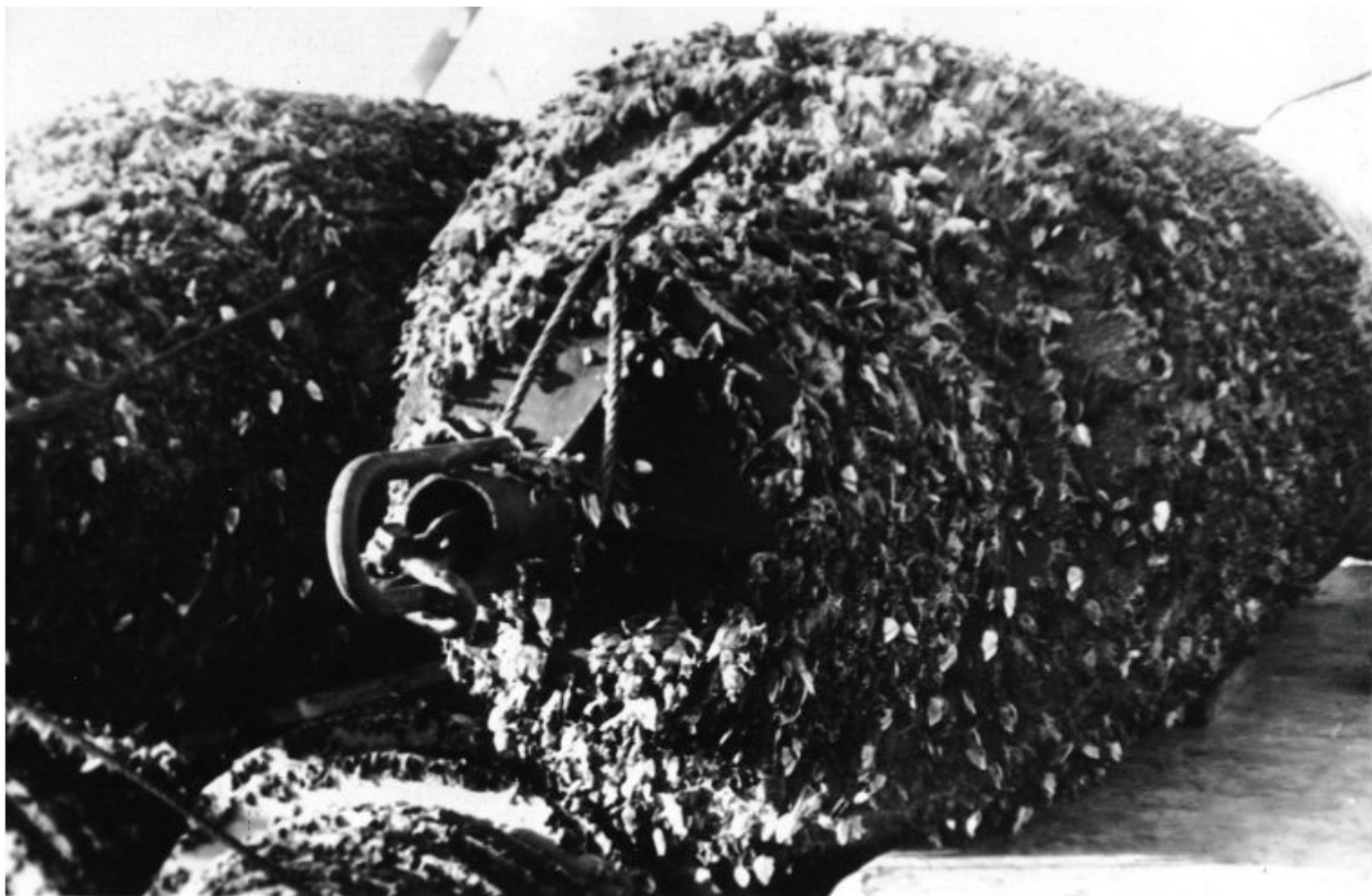
Обрастание буёв, экспонированных 25 суток. Западно-экваториальный район Атлантического океана [Ильин, 2008б].
