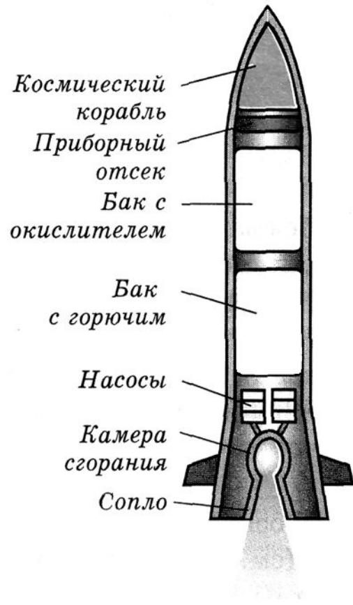
**Ракетный двигатель (РД)** - реактивный двигатель, использующий для своей работы только вещества и источники энергии, имеющиеся в запасе на перемещающемся аппарате (летательном, наземном, подводном). Т. о., в отличие от воздушно-реактивных двигателей, для работы РД не требуется окружающая среда (воздух, вода).
