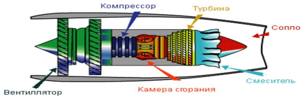
**Воздушно-реактивные двигатели** в настоящее время применяют главным образом на самолетах. Основное их отличие от ракетных двигателей состоит в том, что окислителем для горения топлива служит кислород воздуха, поступающего внутрь двигателя из атмосферы.
