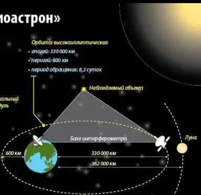
«Радиоастрон» будет работать совместно с международной сетью наземных радиотелескопов, образуя **гигантский наземно-космический телескоп** (т.н. интерферометр) высочайшего углового разрешения.
